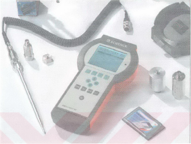
Şekil IV.13 Schenck Vibrotest60, El Tipi Çift Kanallı Titreşim Ölçüm, Analiz Cihazı ve Ekipmanları
