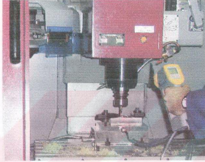
Şekil IV. 27 Malzeme İşlenirken Yapılan Sıcaklık Ölçümü
