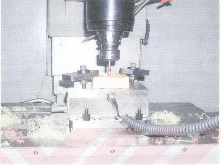
Şekil IV. 28 Dinamometreye Tutturulmuş İvme Sensörü ile Titreşimin Ölçülmesi
