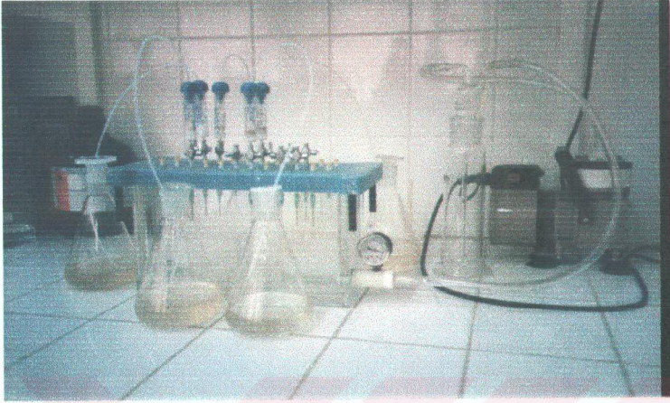
Şekil 3.4.3. Çalışmada kullanılan katı faz ekstraksiyon düzeneği
