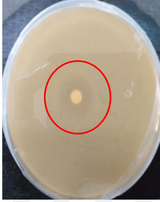
Şekil 8. Optium koşullarda gerçekleştirilen üretim sonrası elde edilen örneğin antibakteriyel testi.
