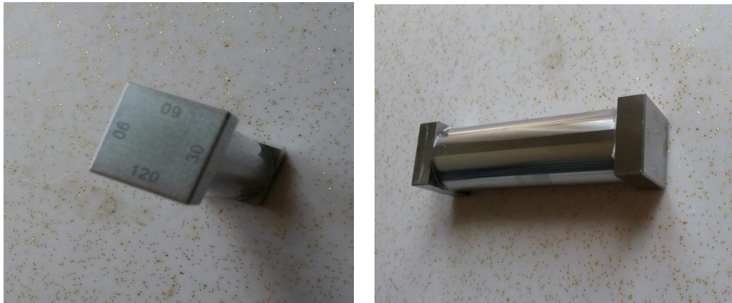
Resim 3.9 Dört yüzlü aplikatörün üstten yandan görünümüleri
