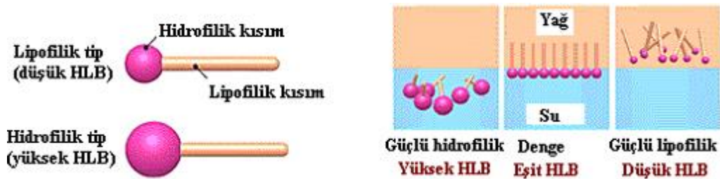
Şekil 2.14 Hidrofil-lipofil denge oluşumunun şematik gösterimi
