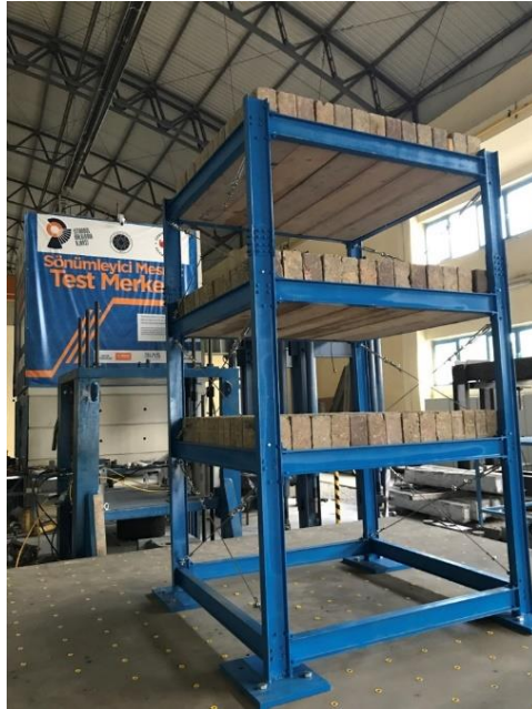
Şekil 2. 1 Sarsma masası deney düzeneği
