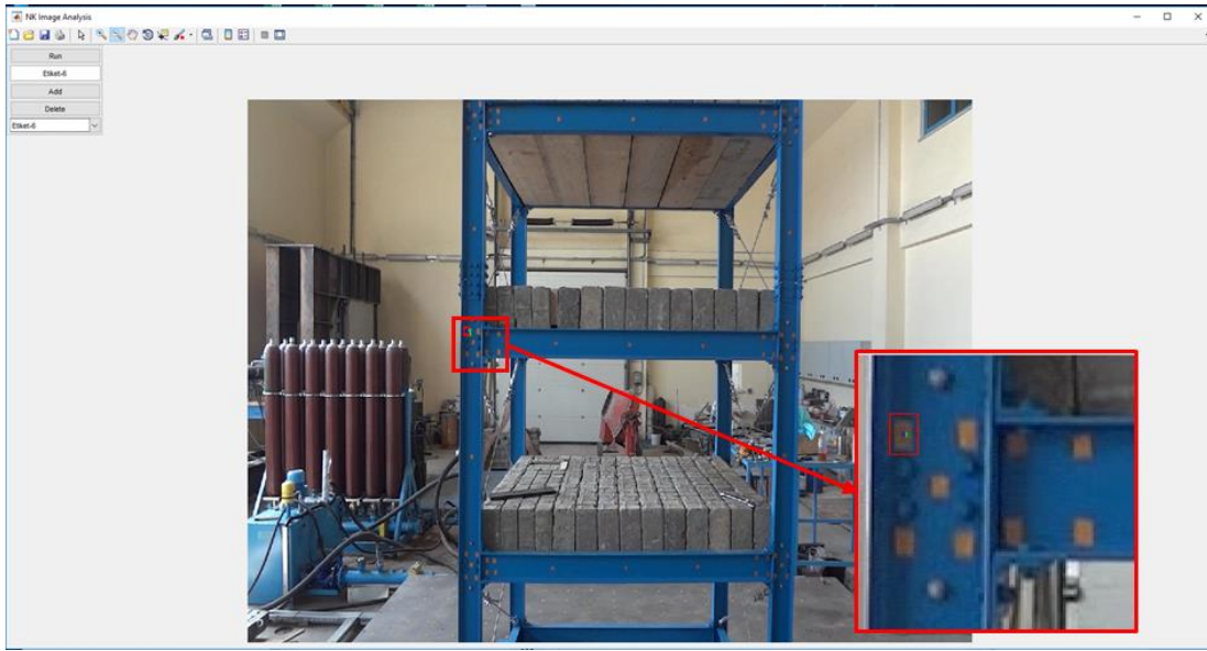
Şekil 3. 6 ROI penceresi yöntemi ile şablon eşleştirme uygulaması
