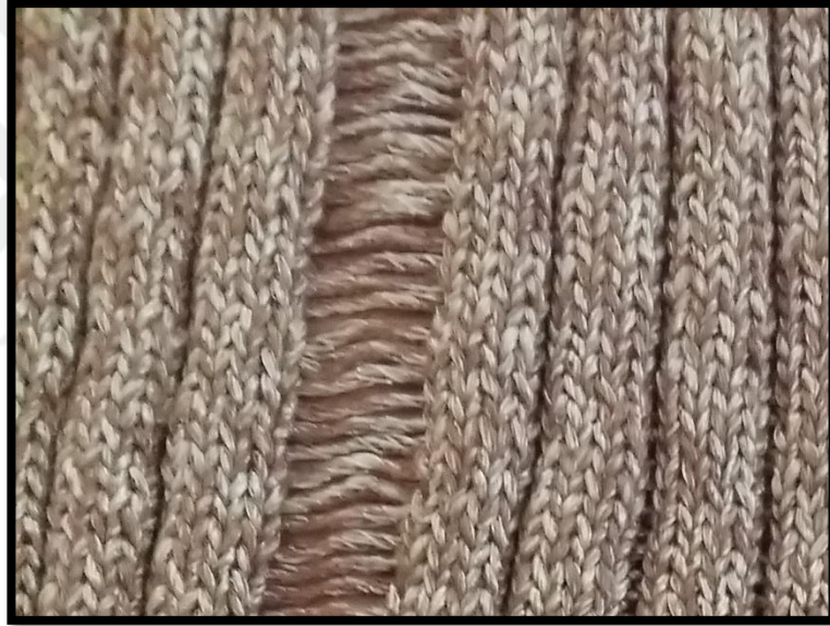
Şekil 207: Atlama yöntemi ile yapılmış kumaş örneği
