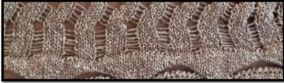
Şekil 206: Atlama yöntemi ile yapılmış kumaş örneği
