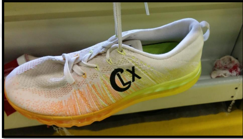
Şekil 189:14 gauge Düz örme(triko) makinesinde üretilmiş ayakkabı
