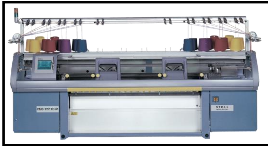
Şekil 9: Stoll CMS düz örgü makinesi
