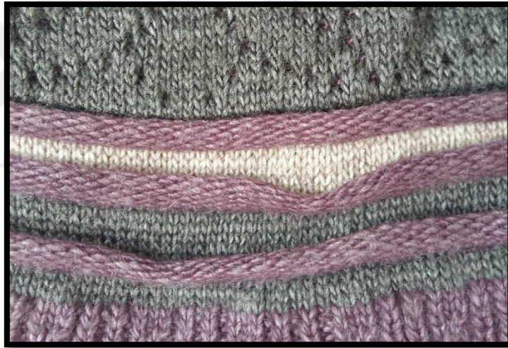
Şekil 213:Plaka düşürme yöntemi ile yapılmış kumaş örneği
