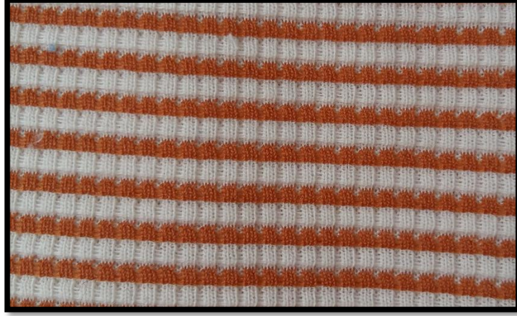
Şekil 236: Biriktirme yöntemiyle yapılmış kumaş örneği
