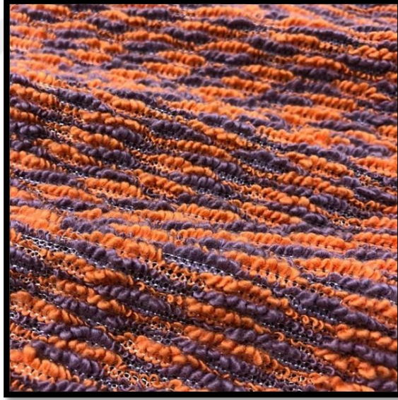
Şekil 223:İplik farklılık yöntemi ile yapılmış kumaş örneği
