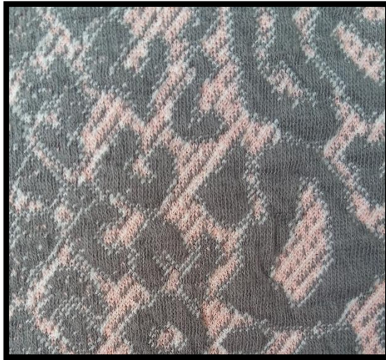
Şekil 251: Torba yöntemiyle yapılmış kumaş örneği
