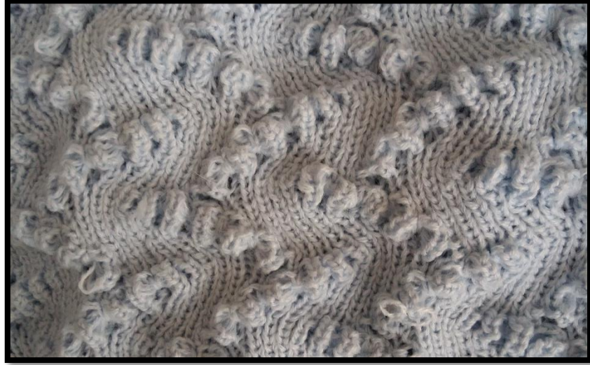
Şekil 211: Biriktirme yöntemi ile yapılmış kumaş örneği
