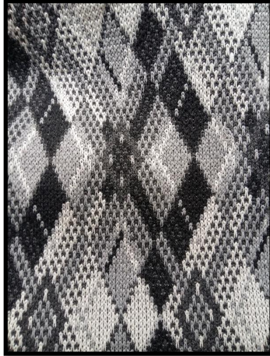
Şekil 219:Jakar yöntemi ile yapılmış kumaş örneği
