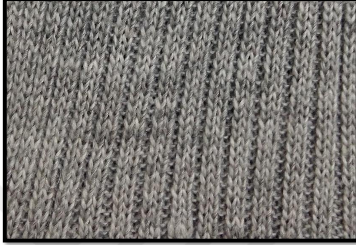
Şekil 54: İki dolu bir boş iğne dizilimi ile yapılmış lastik örgü
