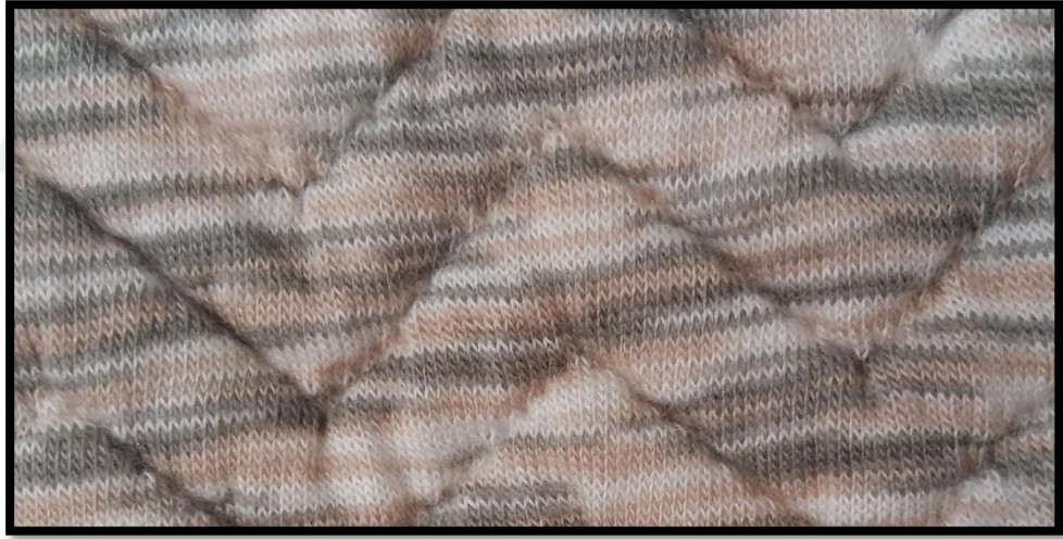
Şekil 249: İplik farklılık yöntemiyle yapılmış kumaş örneği
