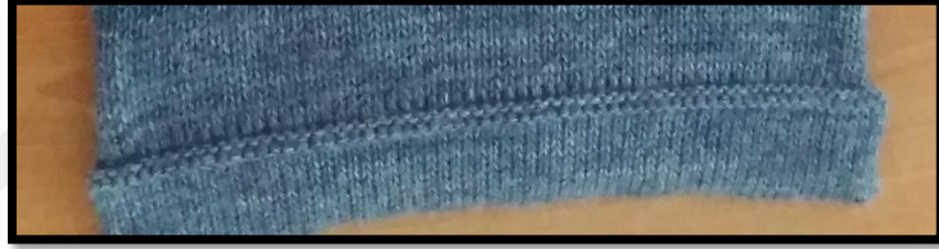
Şekil 225: Torba yöntemi ile yapılmış kumaş örneği
