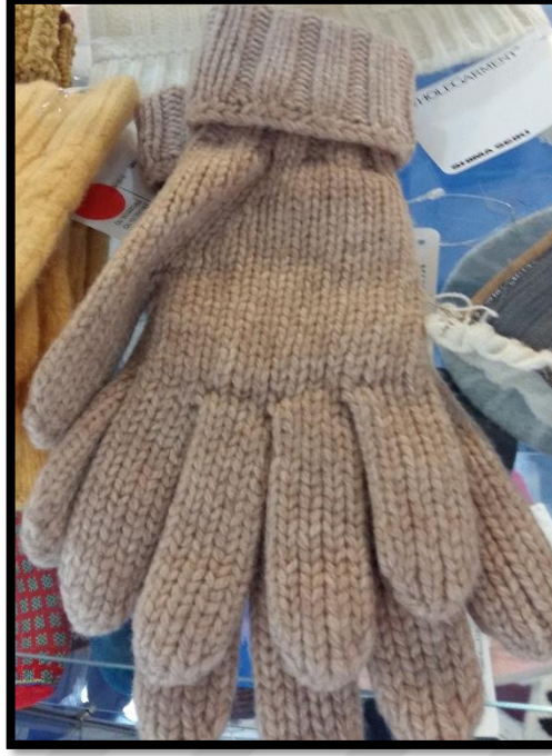
Şekil 106:Çift plaka 7 gauge makinede üretilmiş eldiven örneği
