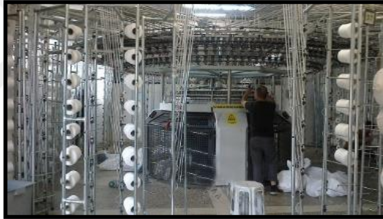
Şekil 22: Çağlık sistemi yanlarda olan yuvarlak örme makinesine bir örnek
