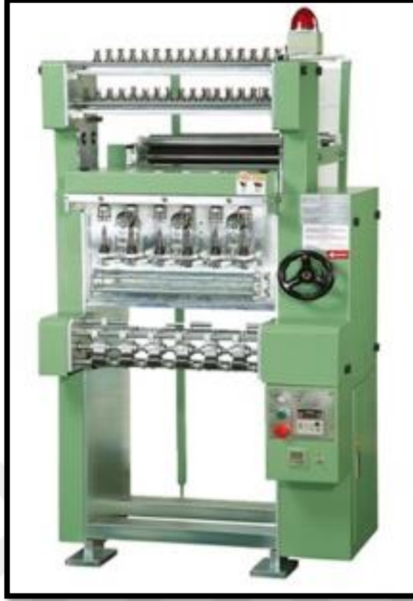
Şekil 153: Üç şerit tertibatlı kordon makinesi
