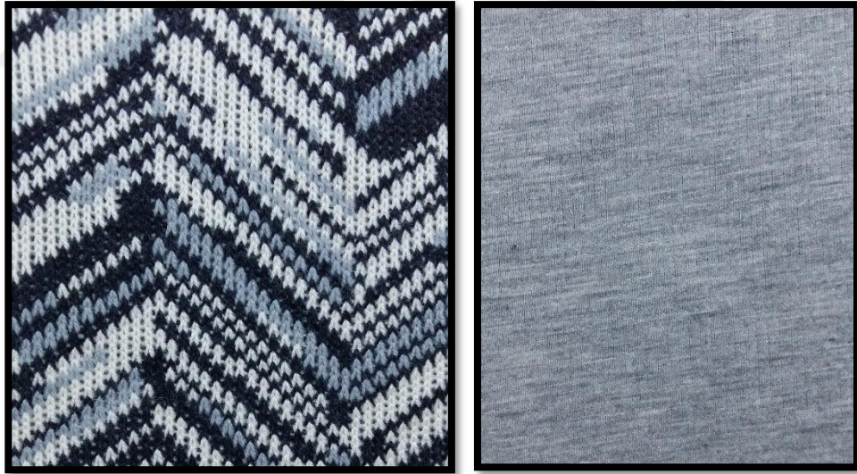
Şekil 94: Double face kumaş ön ve arka yüz görünümü
