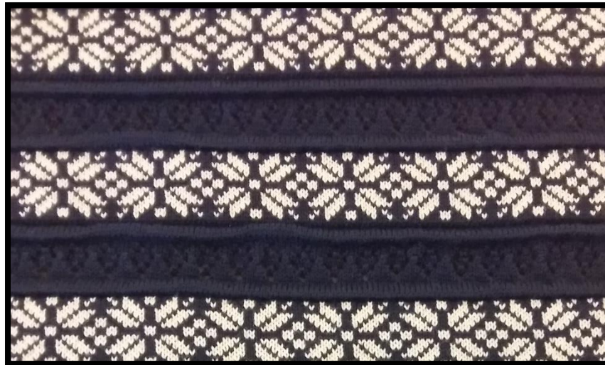
Şekil 217:Jakar yöntemi ile yapılmış kumaş örneği
