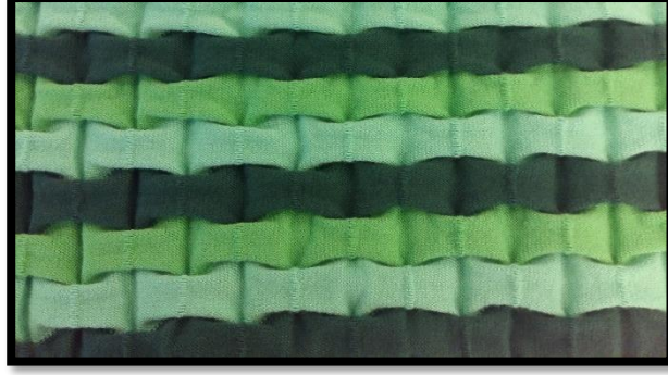
Şekil 224: Torba yöntemi ile yapılmış kumaş örneği
