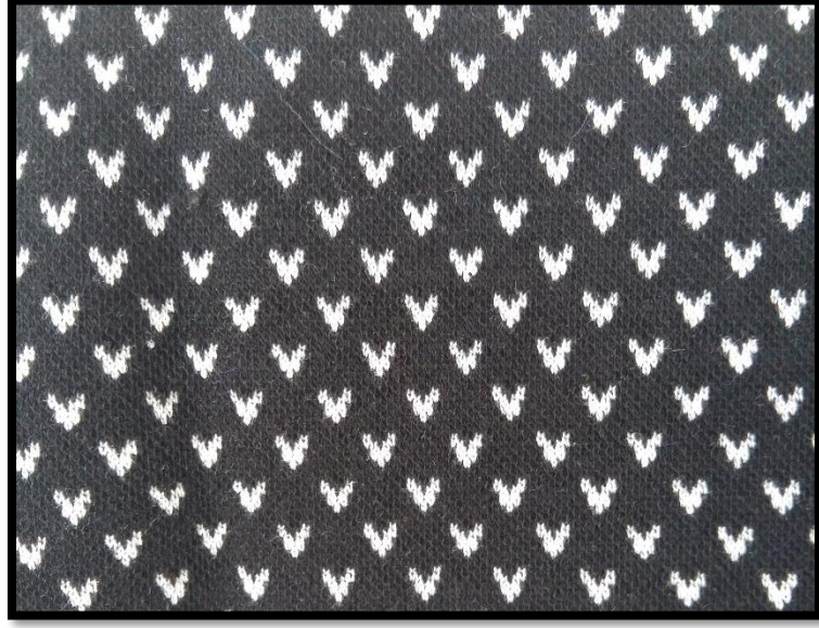
Şekil 244: Jakar yöntemiyle yapılmış kumaş örneği
