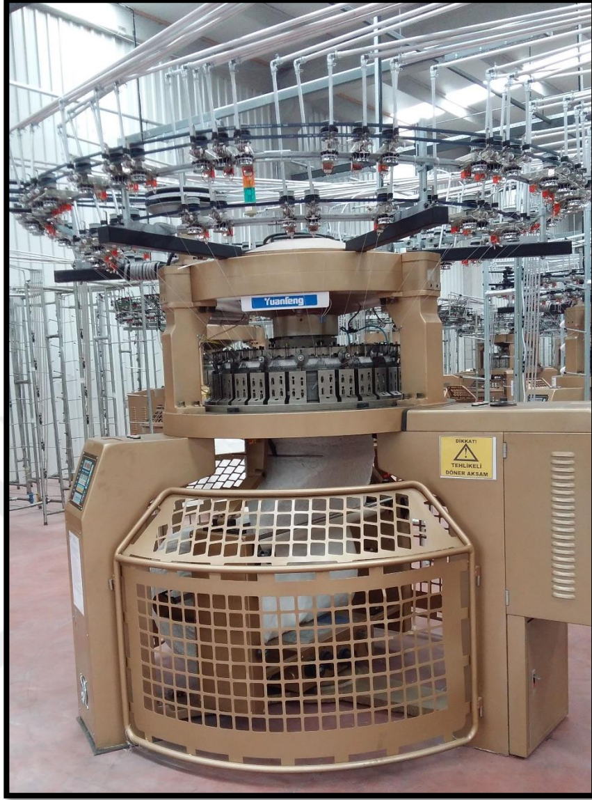
Şekil 104:22 Fine 32 sistem Welsoft yuvarlak örme makinesi
