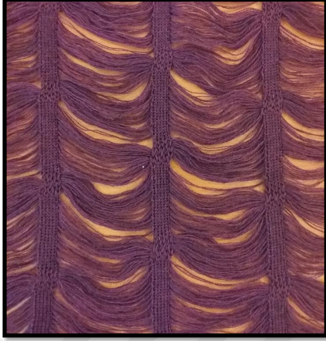
Şekil 208: Atlama yöntemi ile yapılmış kumaş örneği
