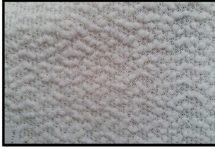
Şekil 247: İplik farklılık yöntemiyle yapılmış kumaş örneği
