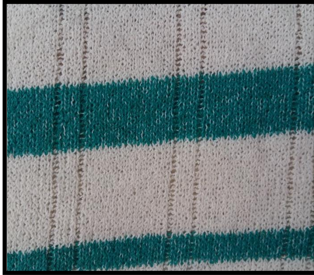
Şekil 231: Atlama yöntemiyle yapılmış kumaş örneği
