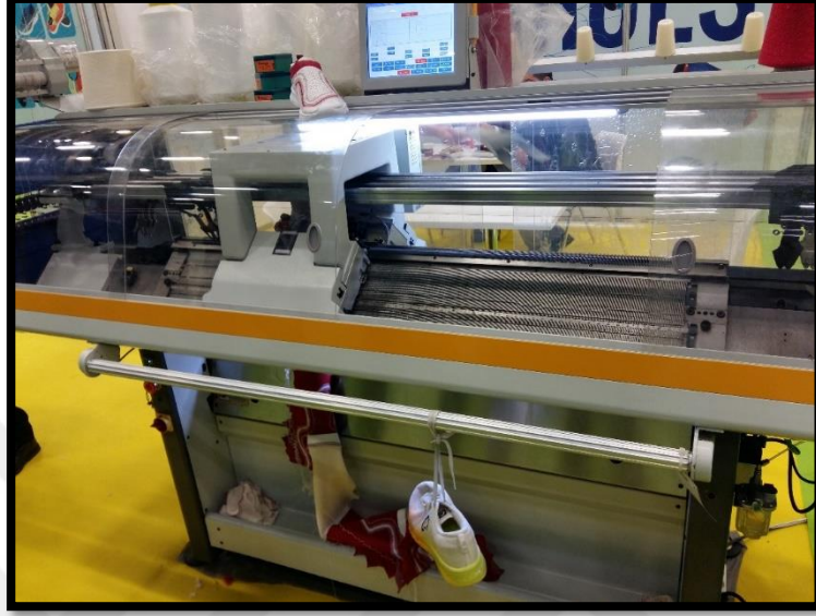
Şekil 186:14 gauge Düz örme(triko) aksesuar makinesi
