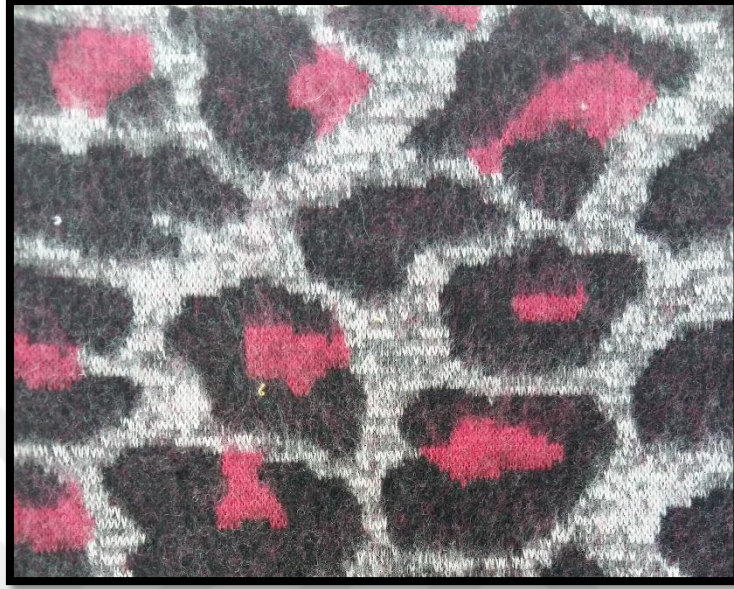
Şekil 238:Jakar yöntemiyle yapılmış kumaş örneği
