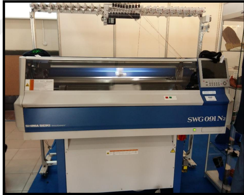
Şekil 168:SWG 091Shima Seiki 14 gauge eldiven üretebilen düz örme makinesi
