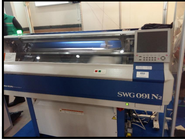
Şekil 172:SWG 091Shima Seiki dikişsiz bitmiş ürün çıkartabilen düz örme makinesi
