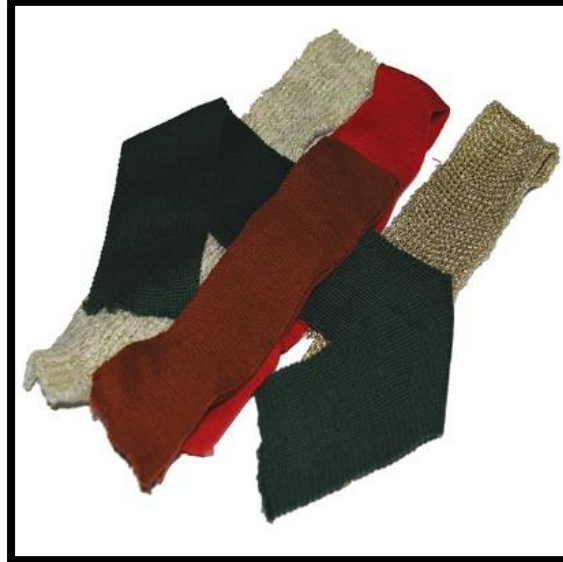
Şekil 156:4 sistemli dar bant düz aksesuar örme makinesinde üretilmiş dar örmeler
