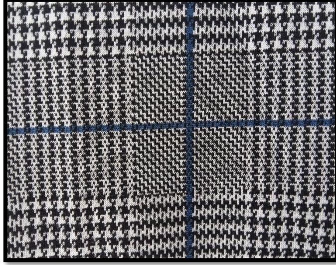
Şekil 242:Jakar yöntemiyle yapılmış kumaş örneği
