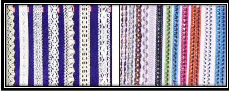
Şekil 39:Kroşet çözgülü örme makinesinde üretilen kumaş örnekleri.
