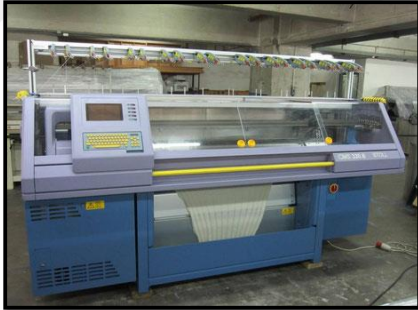
Şekil 24:Stoll düz örme (triko )makinesi
