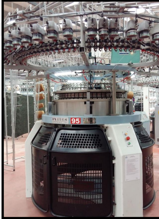
Şekil 31: Çift plaka yuvarlak örme makinesi
