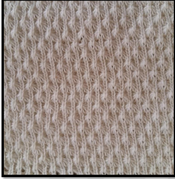
Şekil 204: Askı yöntemi ile yapılmış kumaş tekniği
