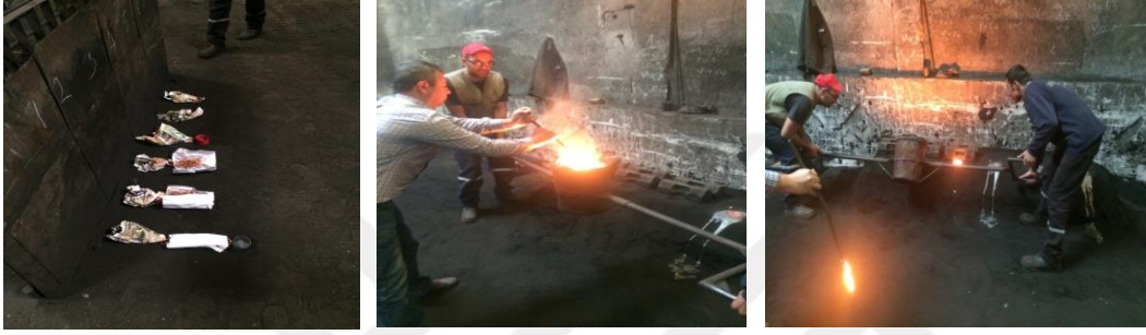
Resim 8.4. Vermikülerleştirme amaçlı ilaveler, karıştırma ve döküm işlemleri
