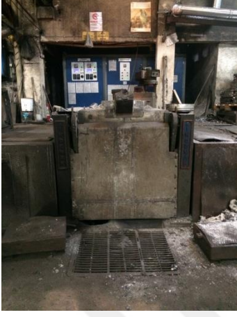
Resim 8.2. 1000 kg Kapasiteli Ergitme İndüksiyon Ocağı
