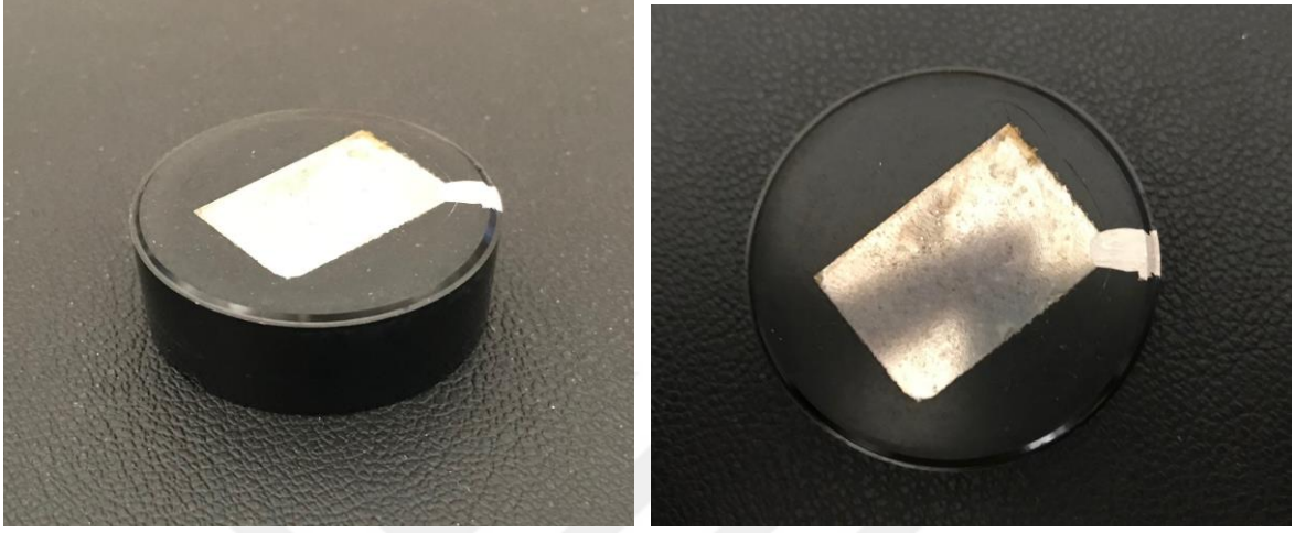
Resim 8.5. Y-Bloklardan alınan ve metalografik inceleme için hazırlanan numuneler
