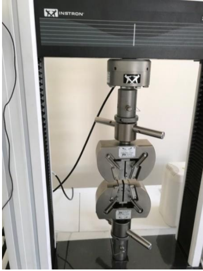
Resim 8.8. INSTRON 3369 Çekme Cihazı
