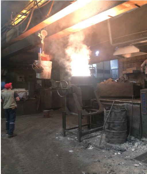
Resim 8.3. Tundish tipi işlem potasında yapılan küreselleştirme işlemi
