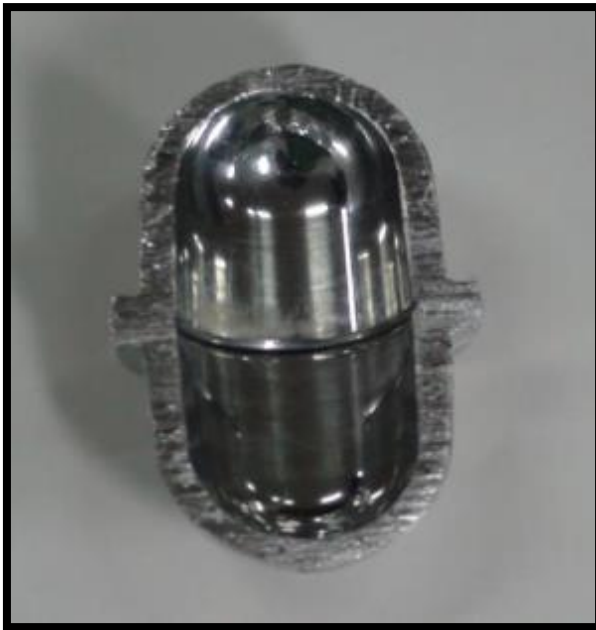
Şekil 3.6. Nihai katot iç yüzey ve kesit gösterimi
