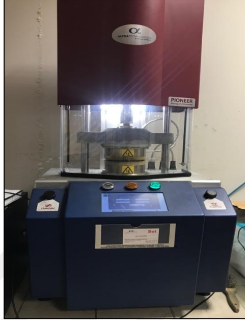
Şekil 1.32. Hareketli kalıp reometresi (Moving die rheometer, MDR)
