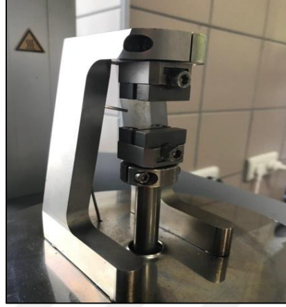
Şekil 1.40. Dinamik mekanik analiz cihazı (DMA) test bölmesi
