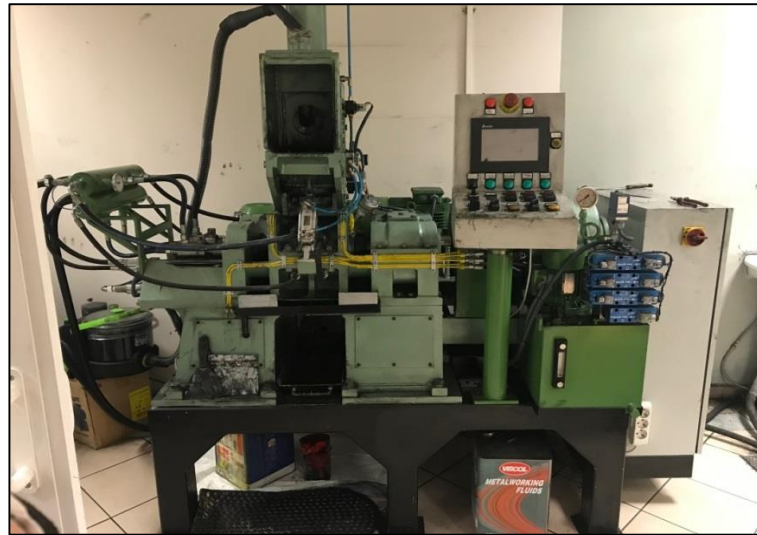
Şekil 1.27. Laboratuvar ölçekli dahili karıştırıcı (Banbury)
