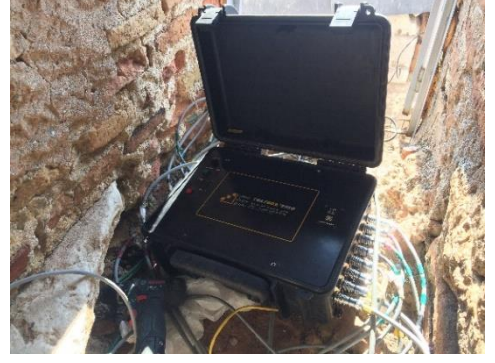
Şekil 5.18 Minare en üst nokta ivme ölçerler ve veri toplama cihazı.
