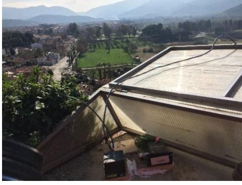
Şekil 5.18 Minare en üst nokta ivme ölçerler ve veri toplama cihazı.
