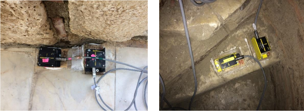
Şekil 5.17 Kaide-zemin ve minare içi ivme ölçerler.
