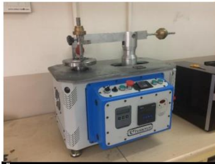
Şekil 7.1. Ball-on-disk tribometre cihazı.
