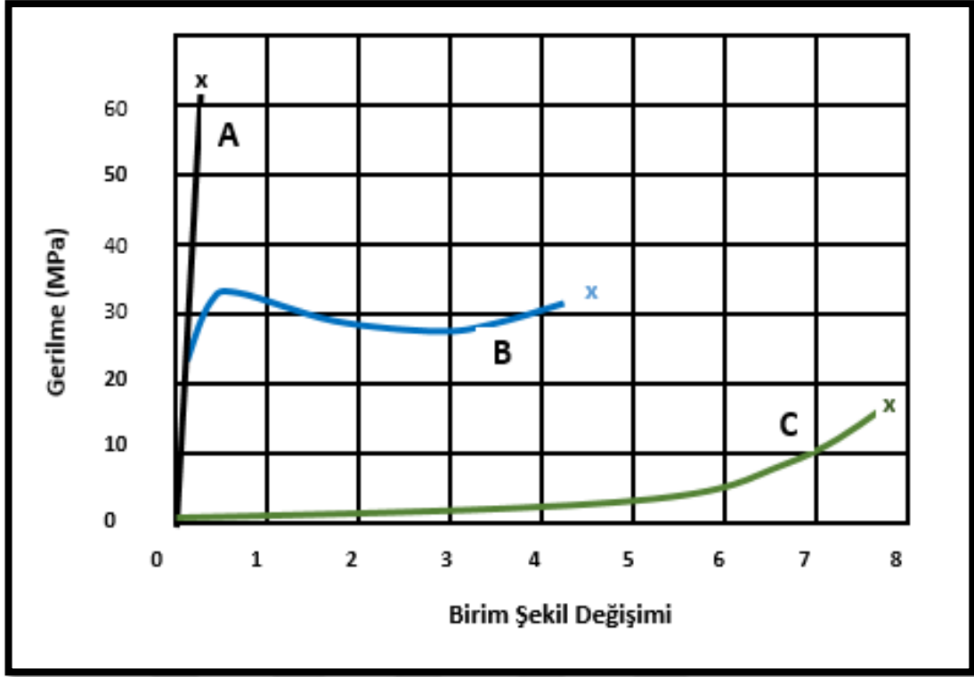
Şekil 3.4: Farklı özellikteki polimer malzemelerin gerilme-birim şekil değişimi davranış grafiği.
