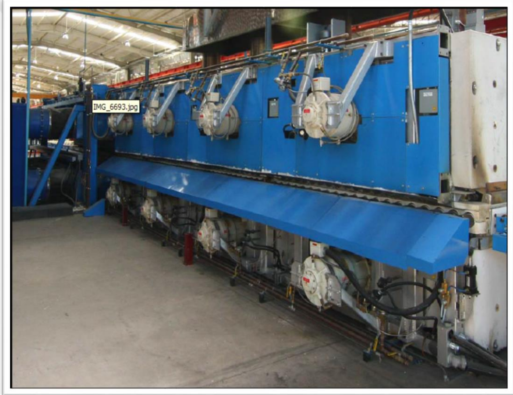
Şekil 3.2. Doğal gazlı cam temperleme fırınında homojenizasyon fanları görünümü
