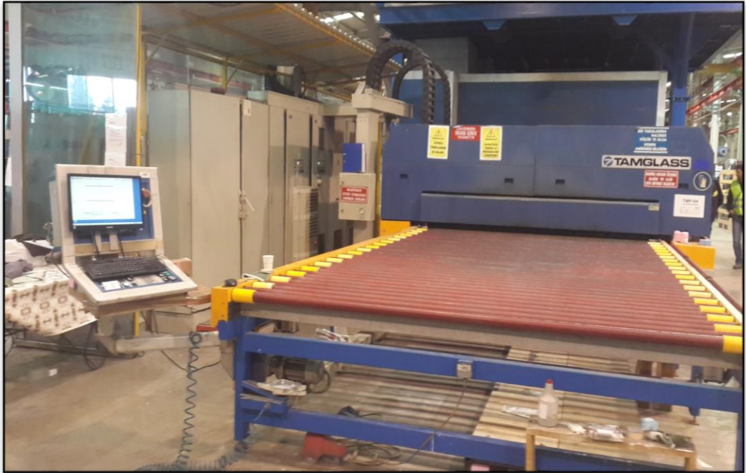
Şekil 4.1. Elektrikli cam temperleme fırınının genel görünümü
