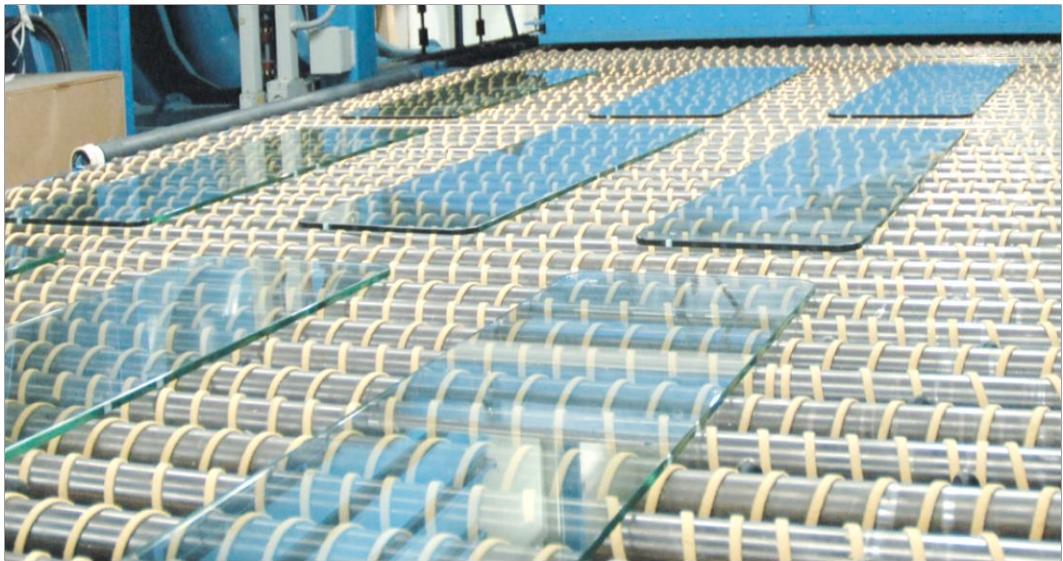
Şekil 1.1. Camların, fırın içerisine temperleme işlemi için yönlendirilmesi
