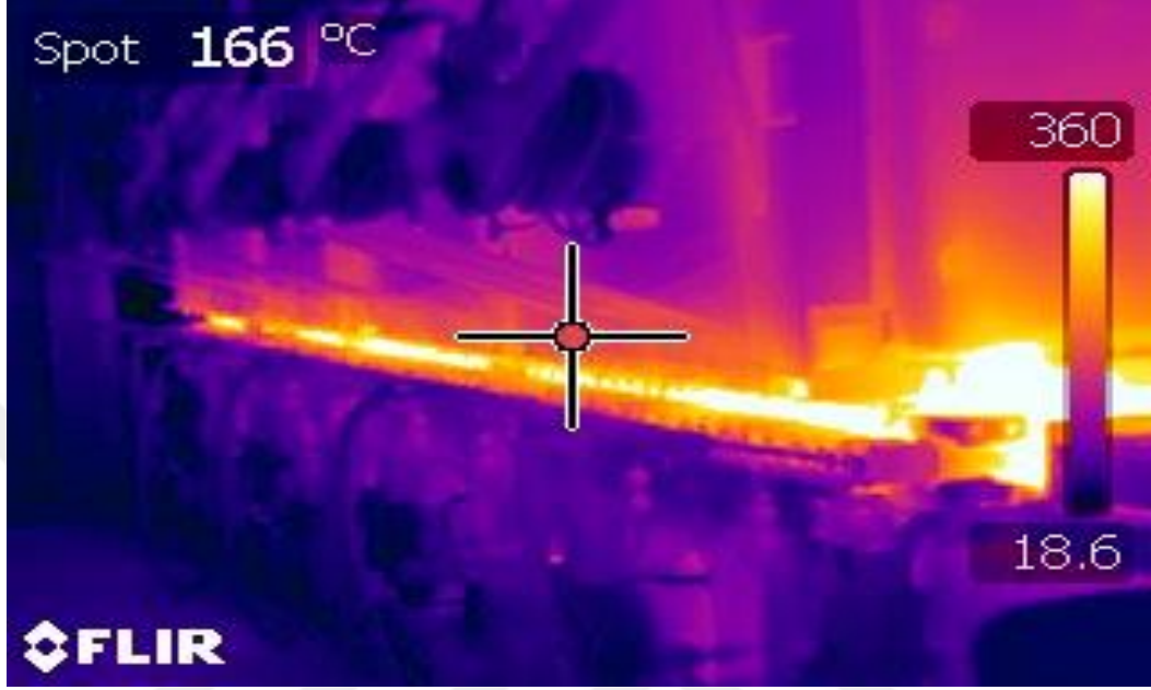
Şekil 5.7. Doğal gazlı fırının yan duvar bölgesi termal kamera görüntüsü
