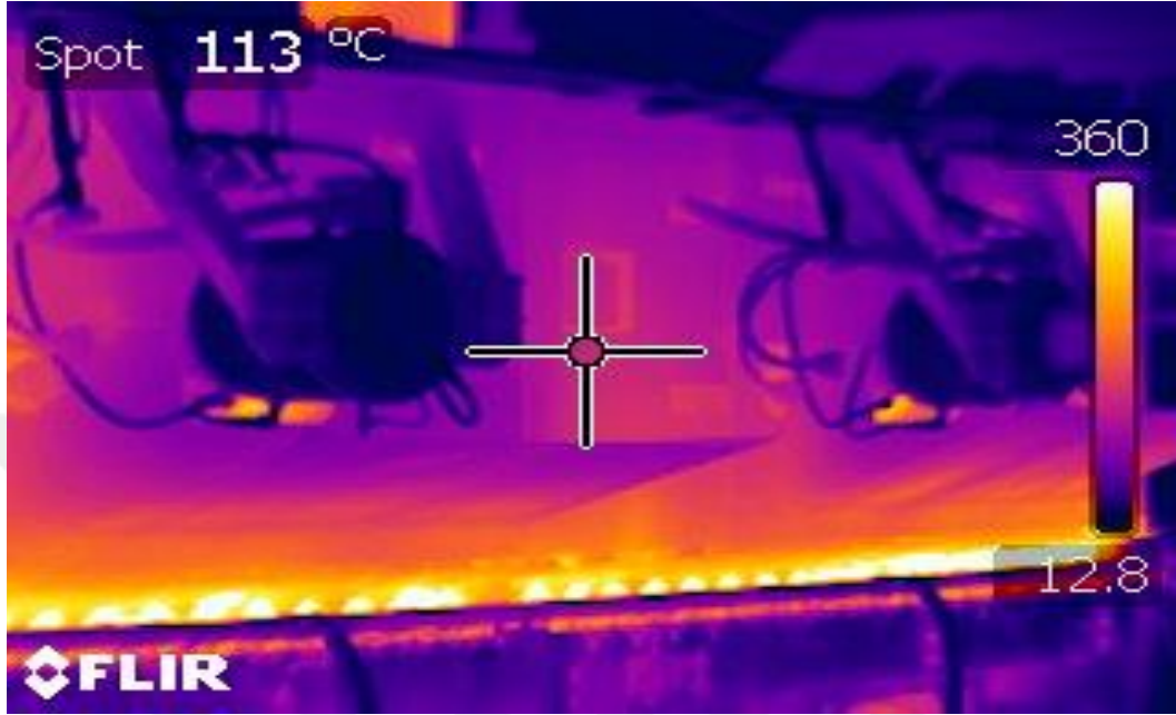
Şekil 5.9. Doğal gazlı fırının homojenizasyon fanları yan duvar bölgesi termal kamera görüntüsü
