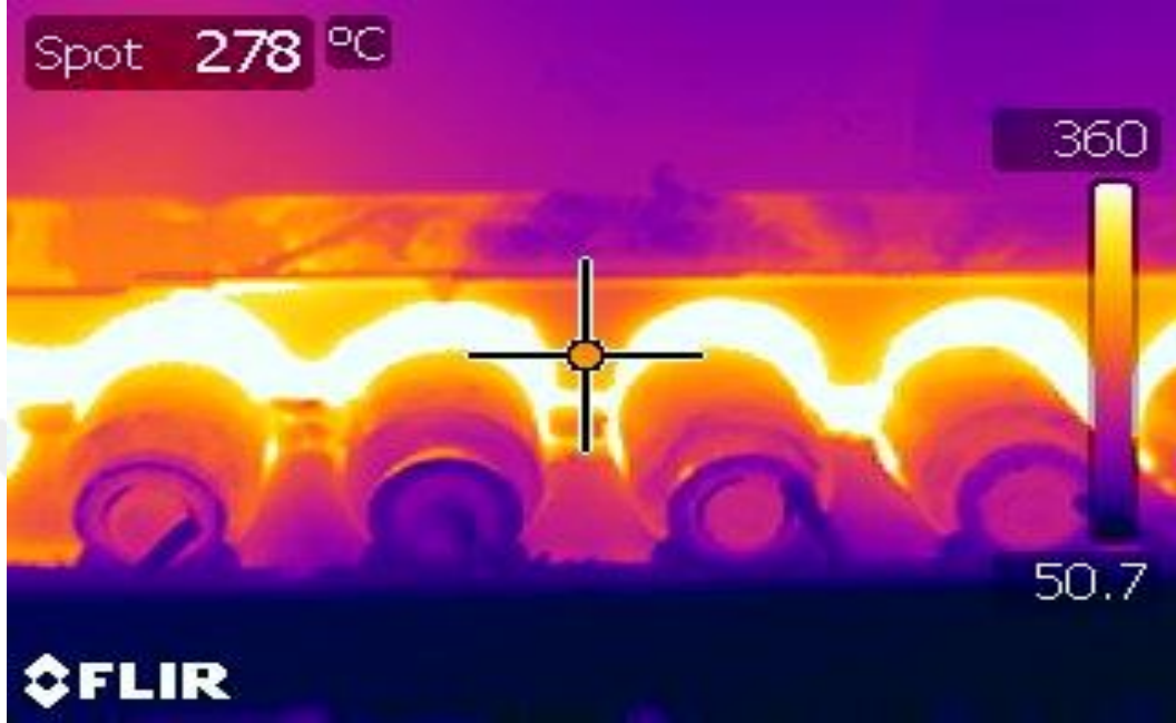
Şekil 5.11. Doğal gazlı fırının konveyör dış bölgesi termal kamera görüntüsü
