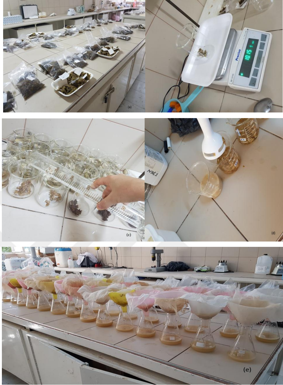
Şekil 3.11 Kıyma makinasında kıyılmış üzümler (a), çözelti hazırlanması (b, c, d) ve süzöntü elde edilmesi (e) işlemleri.
