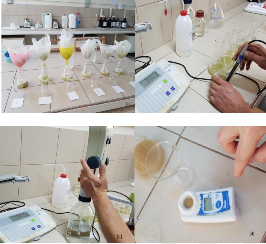
Şekil 3.8 Yaş üzümde yapılan süzdürme işlemi (a) ile pH tayini (b), titre edilebilir asitlik tayini (c) ve suda çözünebilir kuru madde tayini (d).
