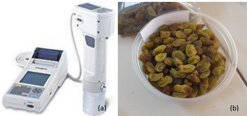
Şekil 3.13. Yaş ve kuru üzümde renk tayininde kullanılan renk ölçer alet (a) ve renk ölçümüne hazırlanmış kuru üzüm örneği (b).
