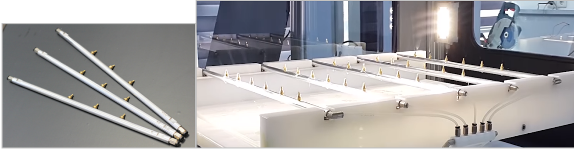
Şekil 3.5. Inovenso elektroçekim cihazının düze sistemi
