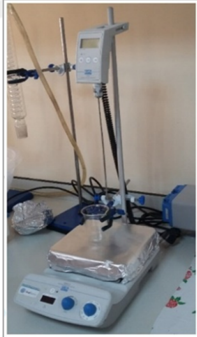
Şekil 3.2. Sıcaklık kontrollü ısıtıcılı manyetik karıştırıcı
