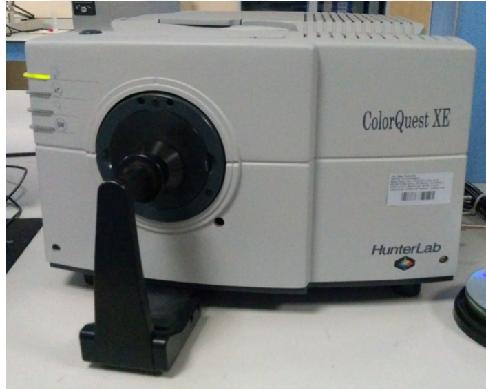
Şekil 3.12. ColorQuest XE HunterLab(CIE L a b) spektrofotometre
