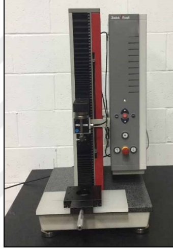
Şekil 3.10. Zwick-Roell BT-1 çekme dayanımı test cihazı
