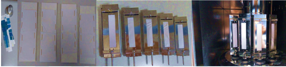
Şekil 4.60. Xenotest 150 S+ cihazına numunelerin hazırlanması
