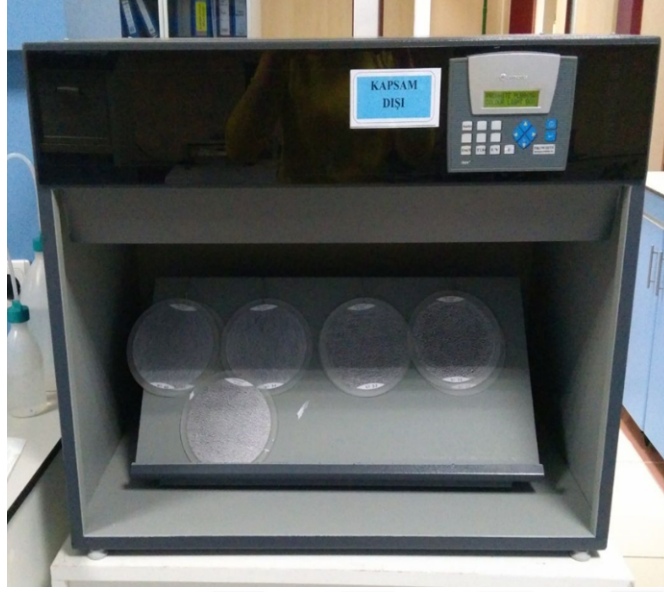
Şekil 3.13. Prowhite PL B065A Colour Light Box ışık kabini
