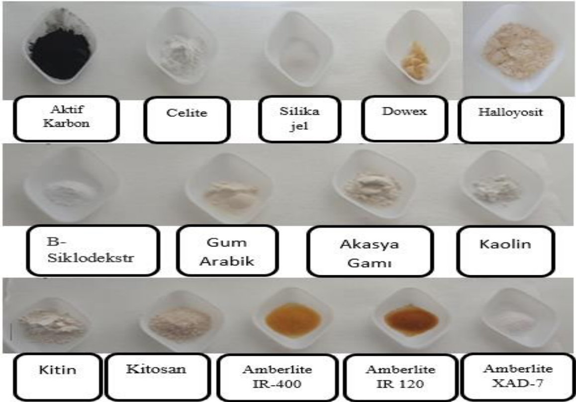
Şekil 3. 1. Greylfurt Çekirdek Yağının Acılığını Gidermek İçin Kullanılan Adsorban Mad-deler.
