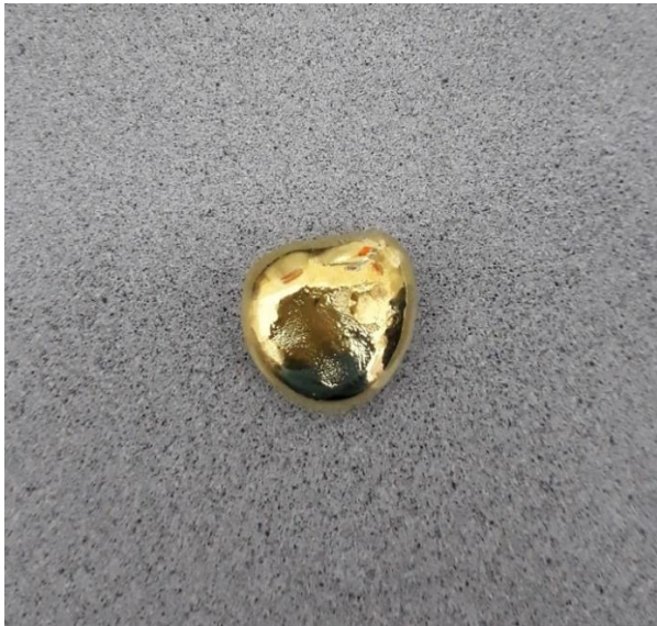
Resim 7.1. Deneylerden geri kazanılıp dökümü yapılmış altın külçesi
