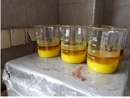
Resim 5.5. Üre ve SMB eklenmiş stok çözeltiler
