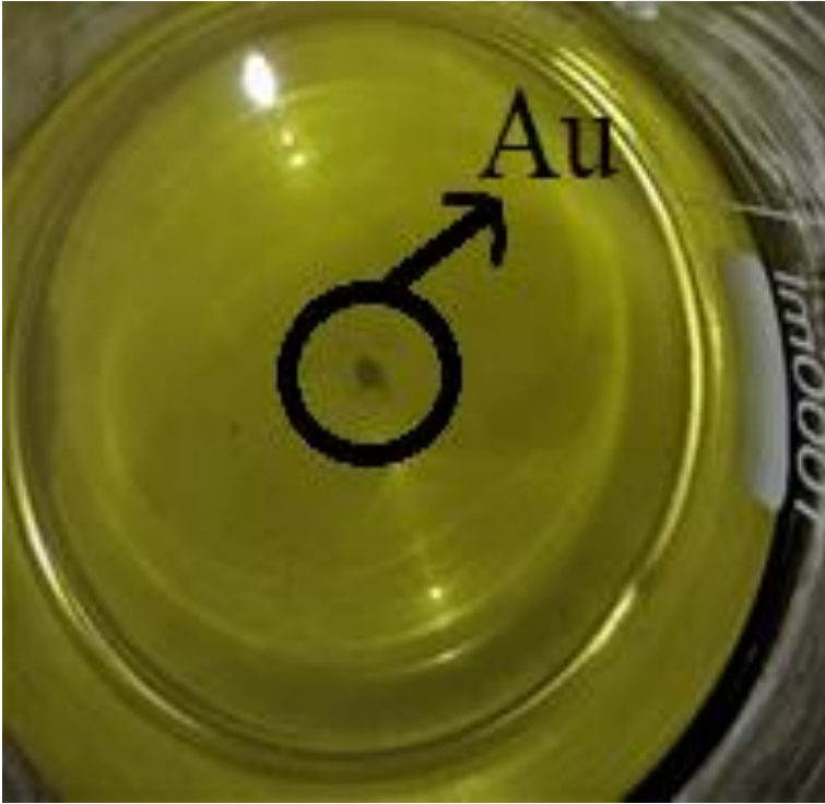
Resim 5.6. Dibe çöken altın partikülleri
