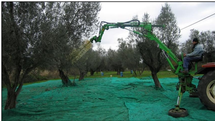
Şekil 3.7. Traktör bağlantılı döner taraklı zeytin hasat makinası
