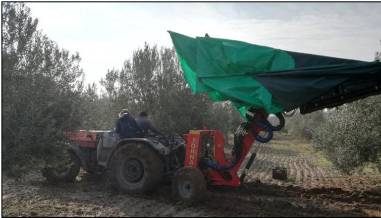
Şekil 3.6. Traktöre ön bağlantılı gövde sarsıcı zeytin hasat makinası
