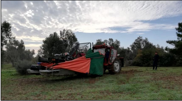
Şekil 3.5. Traktöre arka bağlantılı gövde sarsıcı zeytin hasat makinası
