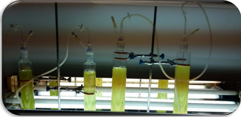
Şekil 3-3 1 L ve 2 L kabarcık kolon reaktörlerde mikroalg üretimi
