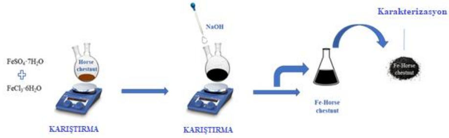
Şekil 5.4. Yabancı kestane dış kabuğuna manyetik özellik kazandırma.
