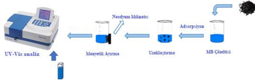
Şekil 5.6. Fe 3 O 4 -YK adsorpsiyon prosesinin şematik gösterimi.
