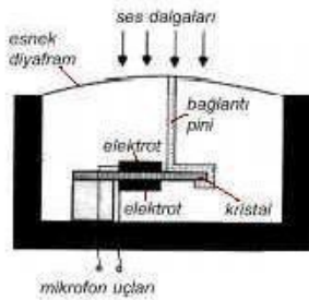
Şekil 2.6. Piezoelektrik kristalli mikrofonun yapısı
