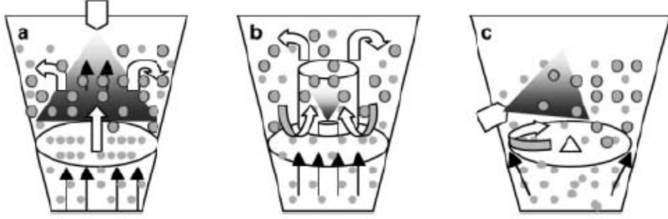
Şekil 1.13. Farklı tipteki akışkanlaştırıcı yataklar (a) yukarıdan püskürtmeli (b) aşağıdan püskürtmeli (c) teğetsel püskürtmeli (Ghosh,2006)
