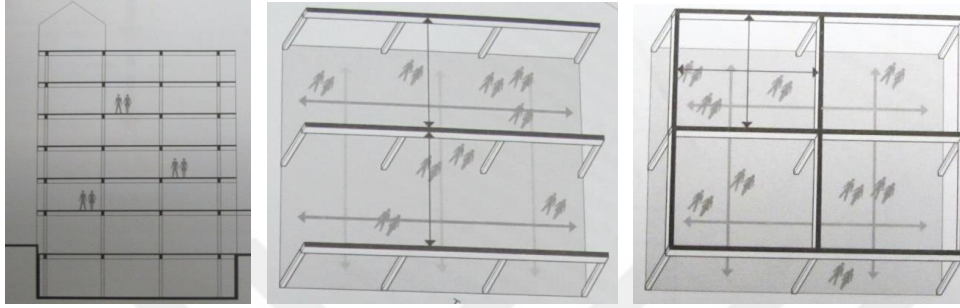
Şekil 5.1. İskelet strüktür sistem, kolon-kiriş sisteminden örnekler
