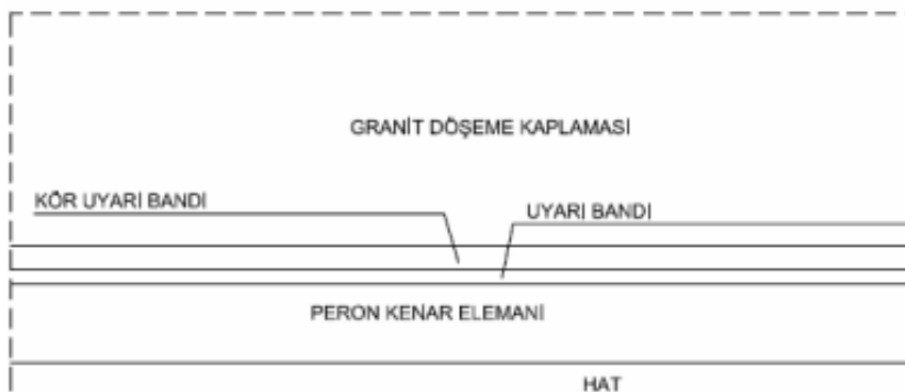
Şekil 3.9. Peron kenarı ikaz bant yerleşimi [27]
