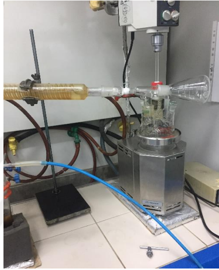
Şekil 4.4 Biyo Esaslı Poliöl Sentezi Deney Düzeneği
