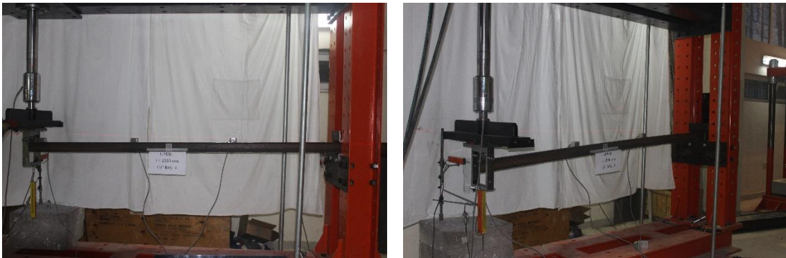
Resim 5.3. Deney elemanı-2 için deforme olmuş ve olmamış hal
