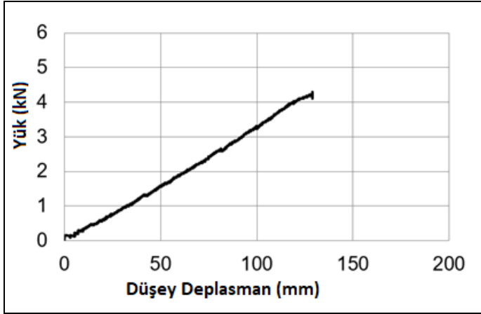
Őekil 5.13. Deney elemanı 5 için yük - düşey deplasman grafiđi
