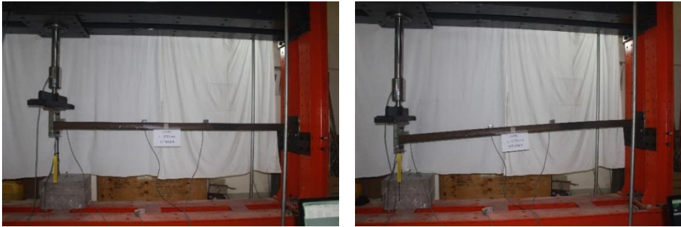
Resim 5.5. Deney elemanı-4 için deforme olmuş ve olmamış hal
