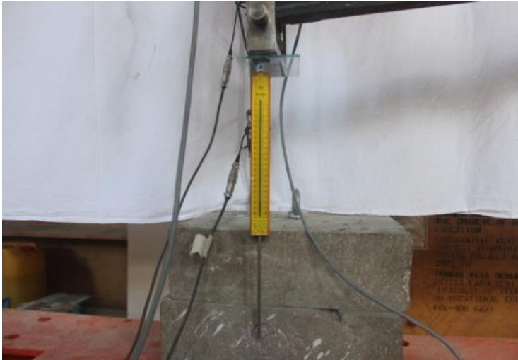
Resim 4.3. Dşey deplasman iin kullanılan LVDT lm cihazı
