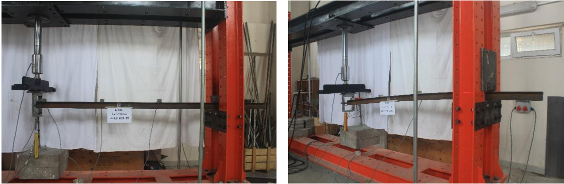
Resim 5.10. Deney elemanı-9 için deforme olmuş ve olmamış hal
