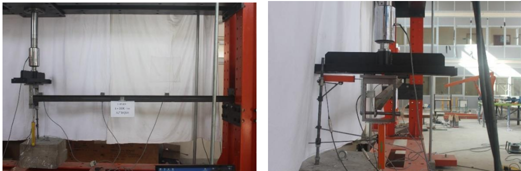
Resim 5.6. Deney elemanı-5 için deforme olmuş ve olmamış hal
