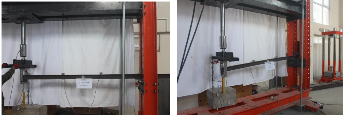
Resim 5.7. Deney elemanı-6 için deforme olmuş ve olmamış hal
