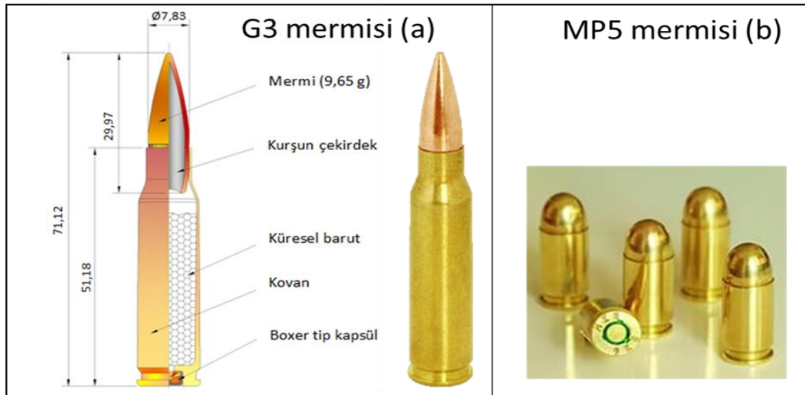
Şekil 5.20. (a) 7,62 mm x51 (M80) normal fişek ve (b) 9 mmx19 parabellum tabanca fişegi (Karakoç, 2017; Alizadeh, 2013)
