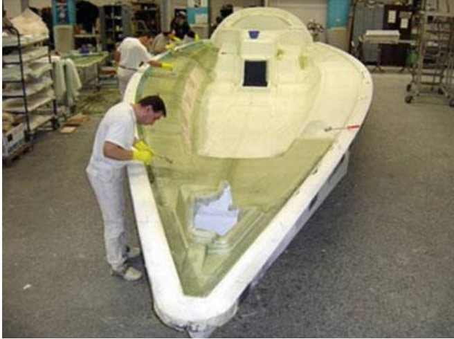
Resim 3.3. Tekne gövdesinin el yatırması yöntemiyle üretimi (Krishnaraj, 2013)
