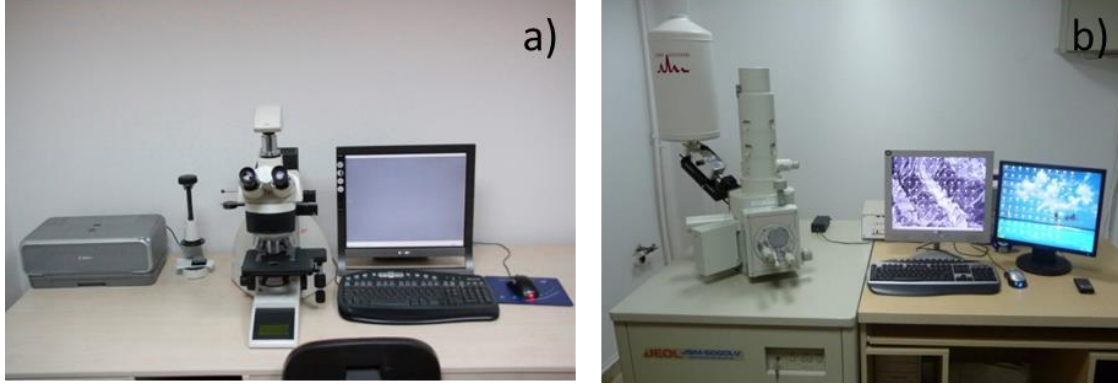
Resim 5.3. (a) Leica DM4000M optik mikroskop, (b) JEOL JSM 6060LV marka taramalı elektron mikroskobu
