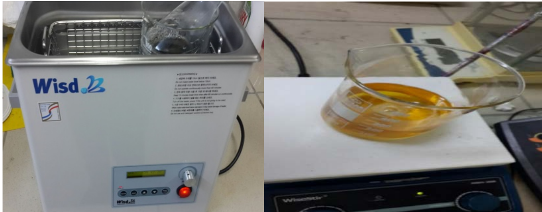
Şekil 3.1.: nZVI'nin sonikatördeki aşaması
