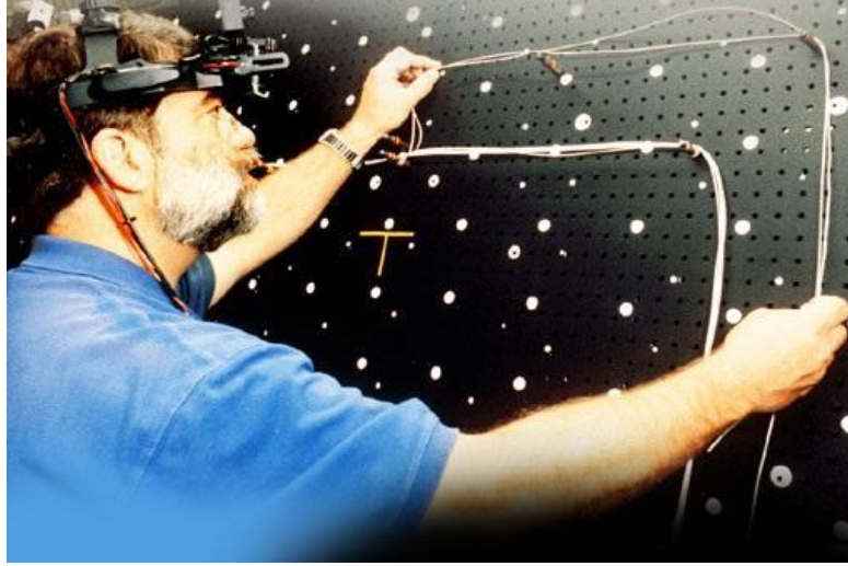
Şekil 2. 21 Caudell ve Mizell tarafından geliştirilen AG sistemi [61].
