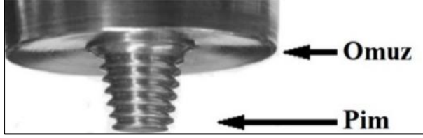
Resim 2.15. Karıştırıcı uç parça bölge tanımlarının gösterimi (Meilinger ve Török, 2013)
