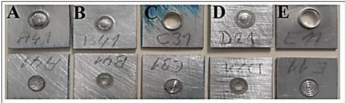
Resim 3.26. AZ31B magnezyum alaşımı levhaların birleştirme parametresi karıştırıcı uç omuz profili A, B, C, D ve E tipleriyle birleştirilmiş ve çekme deneyi sonucunda kopartılmış kesme yüzeyleri örnek görüntüleri
