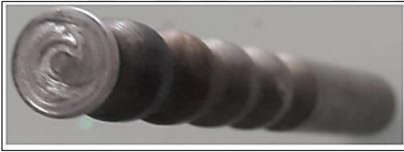
Resim 3.19. Çelik malzeme AISI 1040 (DIN C40)'dan serleştirilmiş (30HRC) karıştırıcı ucu birleştirmeden sonraki (4 tane SKNK) görüntüsü
