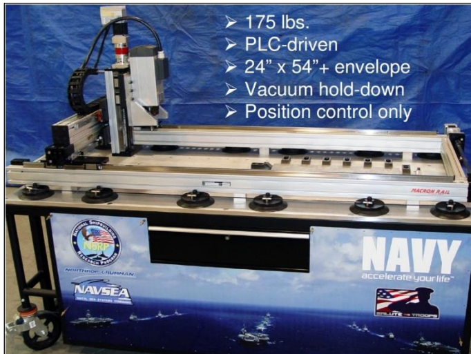
Resim 2.12. Taşınabilen yüksek hızlı SKK makinesi (Whita State University, 2011)
