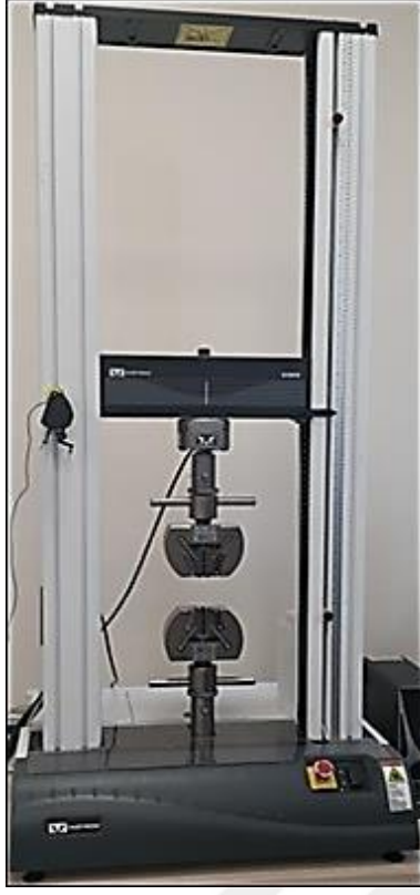
Resim 3.25. INSTRON 3369 Çekme deneyi testi makinası
