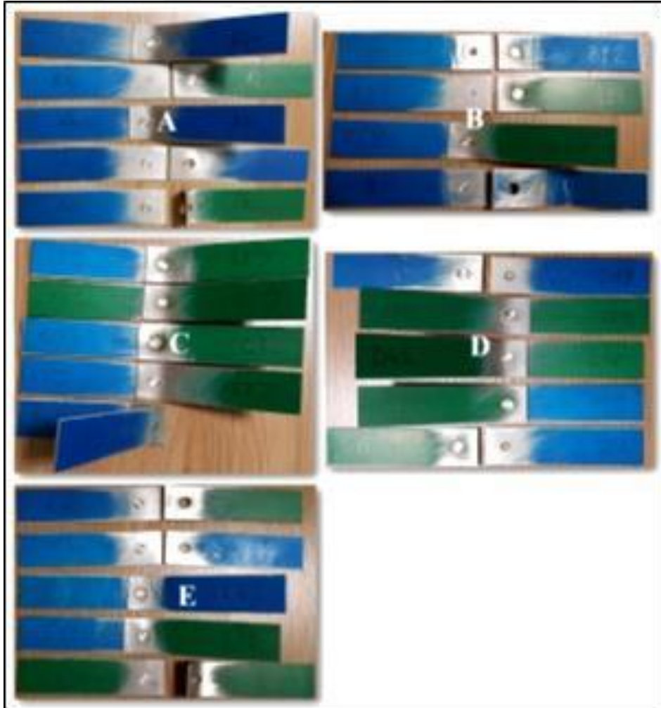
Resim 3.28. AZ31B magnezyum alaşımı numuneleri omuz profil tipi A, B, C, D ve E'ye göre, üç nokta eğme testi sonucu üstten görüntüleri
