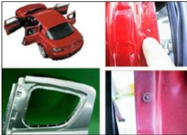
Resim 2.6. Sürtünme karıştırma nokta kaynağı kullanılarak üretilmiş Mazda RX-8'in yan kapı paneli ve noktalarının görünüşü (Badarinarayan ve diğerleri, 2007)
