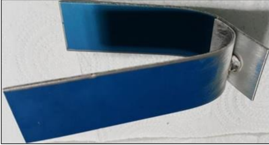
Resim 3.22. SKNK yöntemiyle birleştirilmiş ve 180 derece bükülüp bırakılan 1,5 mm magnezyum numune
