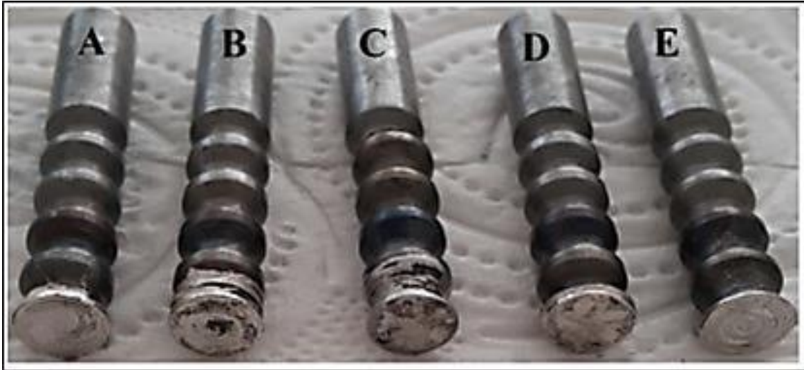
Resim 3.24. Omuz profil tiplerine göre AISI 1040 (DIN C40) malzemeden üretilen karıştırmacı uçlarının ortalama 20 birleřtirme yapıldıktan sonraki görünümü
