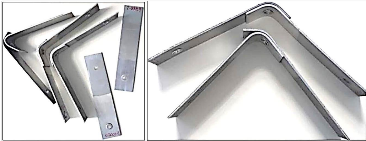
Resim 3.31. AZ31B magnezyum alařımı 1,75 mm kalınlıėındaki saların SKNK ile 2000 ve 1500 devir/dakikada birleřtirildikten sonra  nokta eėme deneyi sonundaki grnmleri
