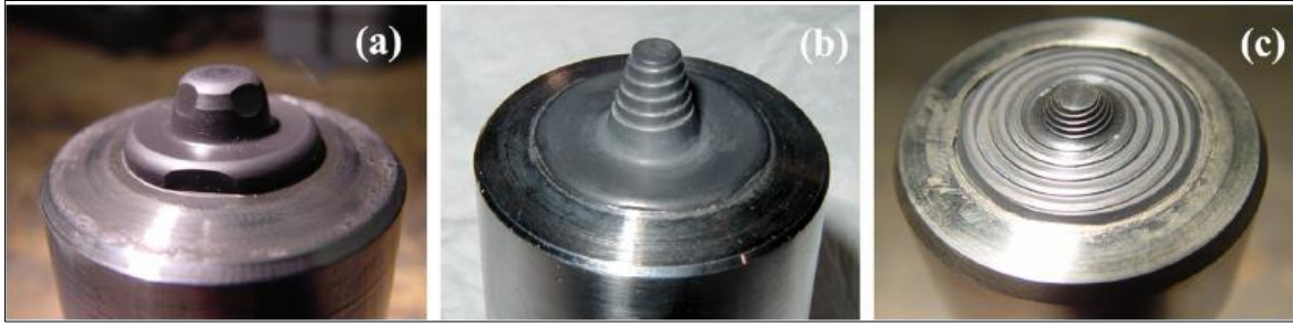
Resim 2.13. PCDN karıştırıcı uç tasarım evrimi: a) Normal tasarım, b) Adım spiral tasarımı ve c) Dışbükey kaydırmalı omuz adım spiral tasarımı (Liua ve diğerleri, 2017)
