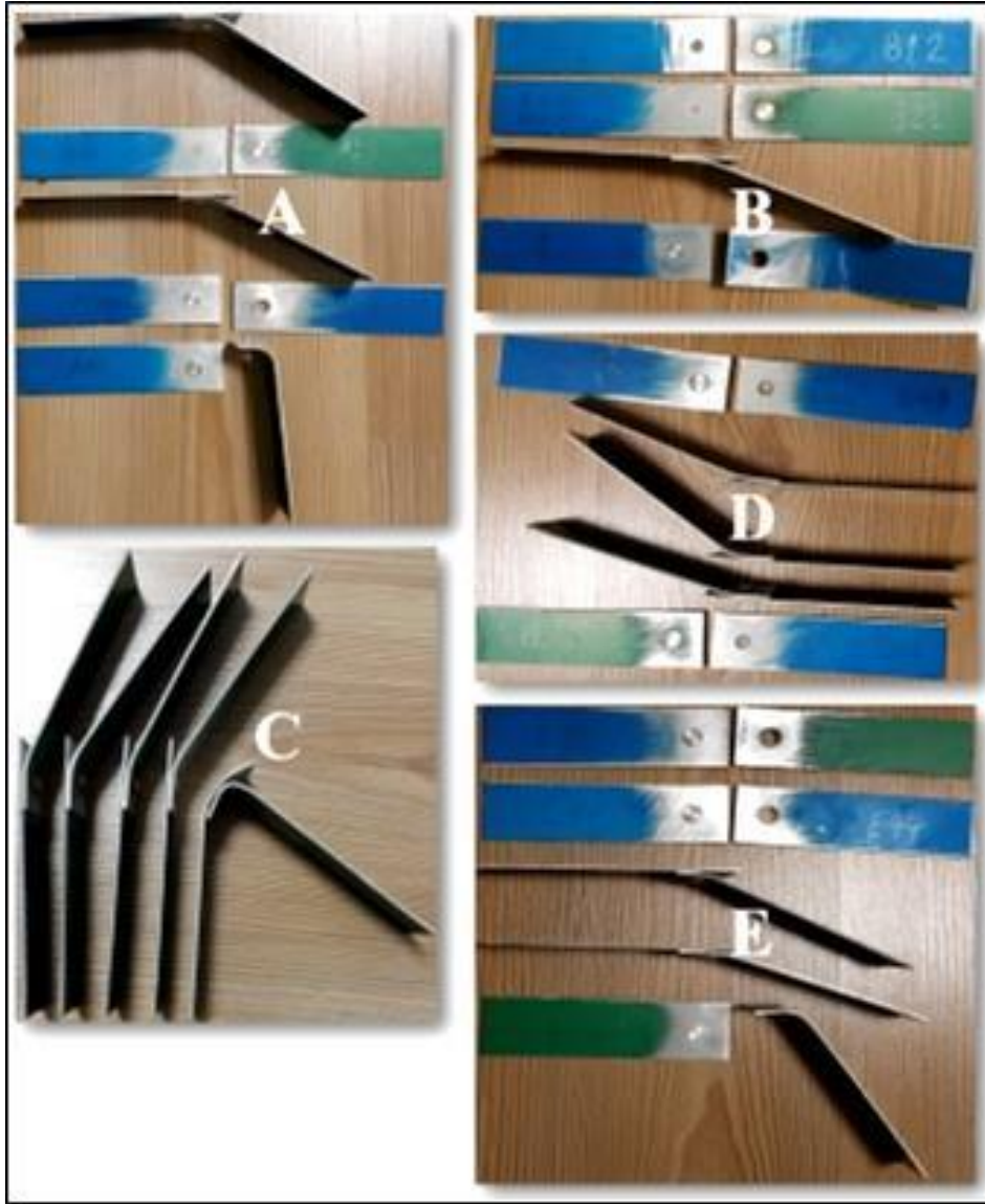
Resim 3.29. AZ31B magnezyum alaşımı numuneleri omuz profil tipi A, B, C, D ve E’ye göre, üç nokta eğme testi sonucu yandan görüntüleri
