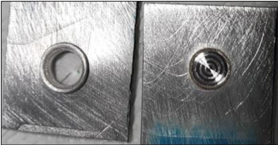
Resim 3.23. Hatalı birleştirme numunesi (E tipi karıştırıcı uç kullanılmıştır)
