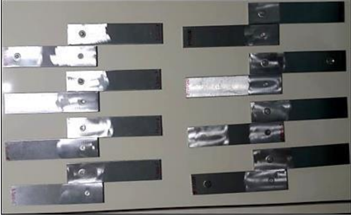
Resim 3.30. Kalınlıėı 1,75 mm magnezyum alařımı AZ31B sa malzemenin 1500 ve 2000 devir/dakika da birleřtirilip, ekme kesme deneyi ile kopartılan birleřme ara yzeyi grntleri
