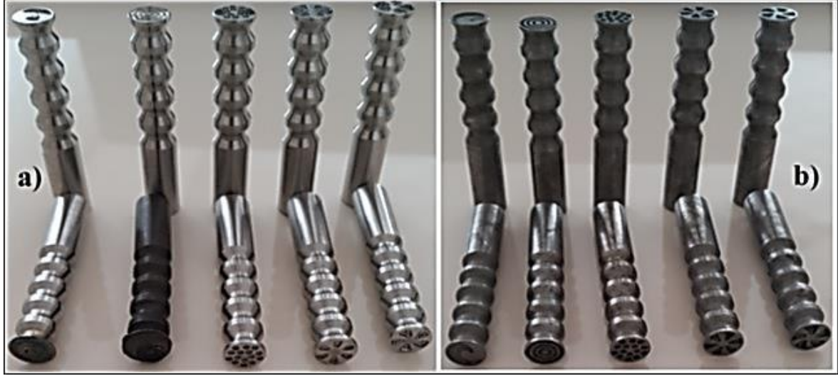
Resim 3.3. a) Östenik ASME SS 321 (X6CrNiTi18-10) paslanmaz çeliğinden üretilen pimler (sertleştirilememiştir) b) AISI 1040 (DIN C40) karbon çeliğinden üretilen karıştırıcı uçları (30 HRC sertleştirilmiştir)
