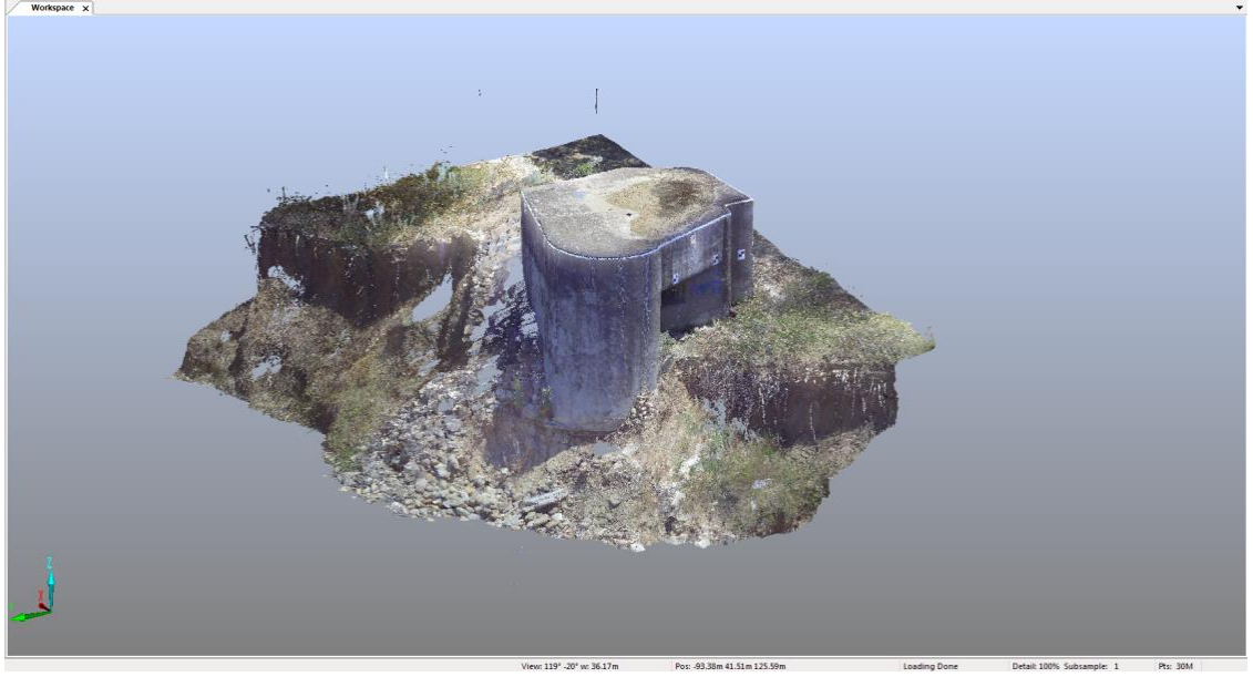
Şekil 4.19. Koruganın nokta bulutu gösterimi
