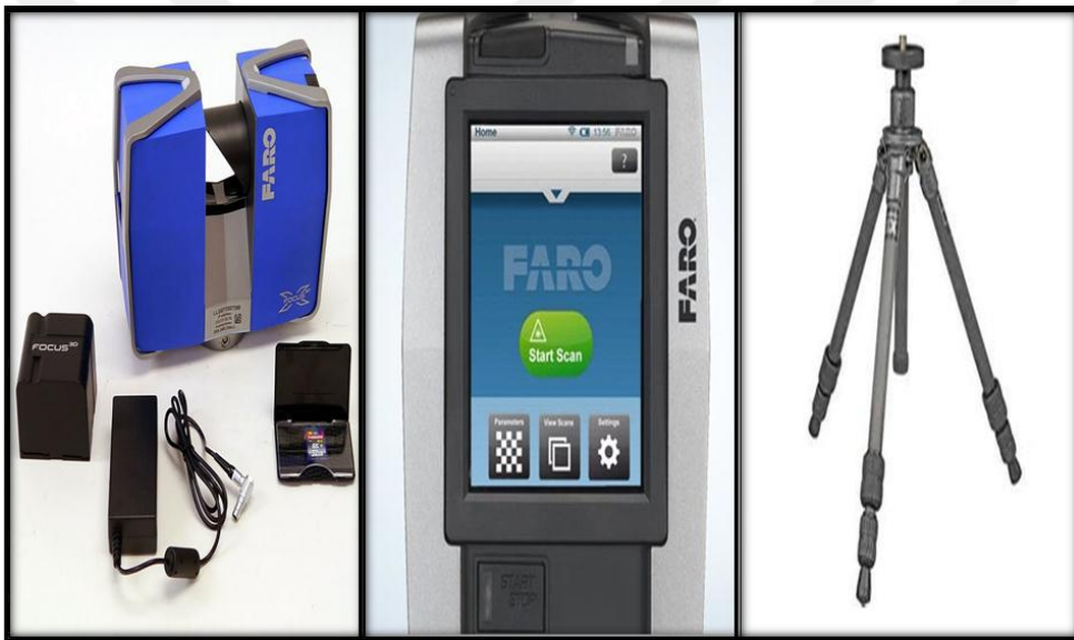
Şekil 3.2. Faro marka yersel lazer tarayıcı ekipmanları örneği
