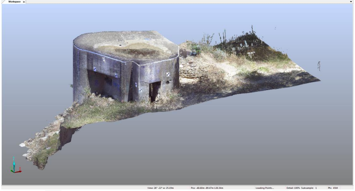
Şekil 4.18. Koruganın nokta bulutu gösterimi
