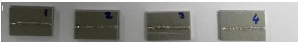
Şekil 5.10. Bindirme kaynak bağlantılı laser kaynak dikişli numunelerden örnek görüntüler AA 6061-T6 Malzeme
