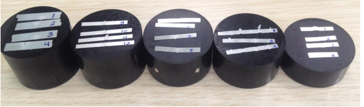
Şekil 6.1. Alın, bindirme ve kör kaynak bağlantılı laser kaynak dikişli numunelerden örnek görüntüler AA 6061-T6 bakalite alınmış halleri
