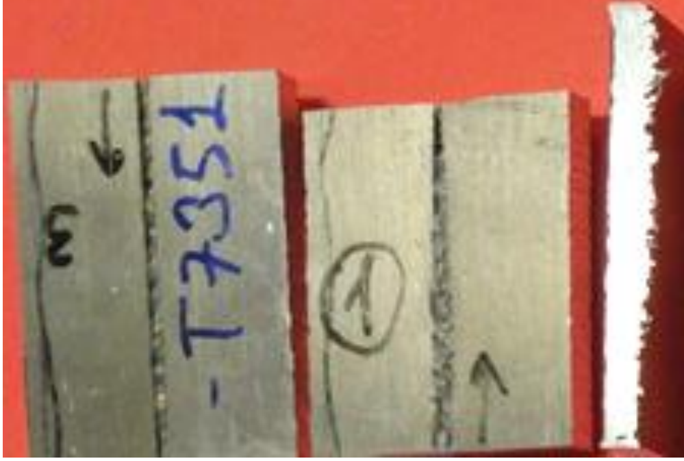
Şekil 5.14. AA 7050-T7351 alın kaynak denemeleri
