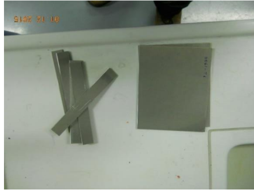
Şekil 5.2. Alüminyum kaynak Numunelerin ve laser kör kaynak dikişlerin örnek görüntüleri, (Numunelerin ebatları ( uzunluk genişlik kalınlık (20 mm x 10 mm x 5 mm)
