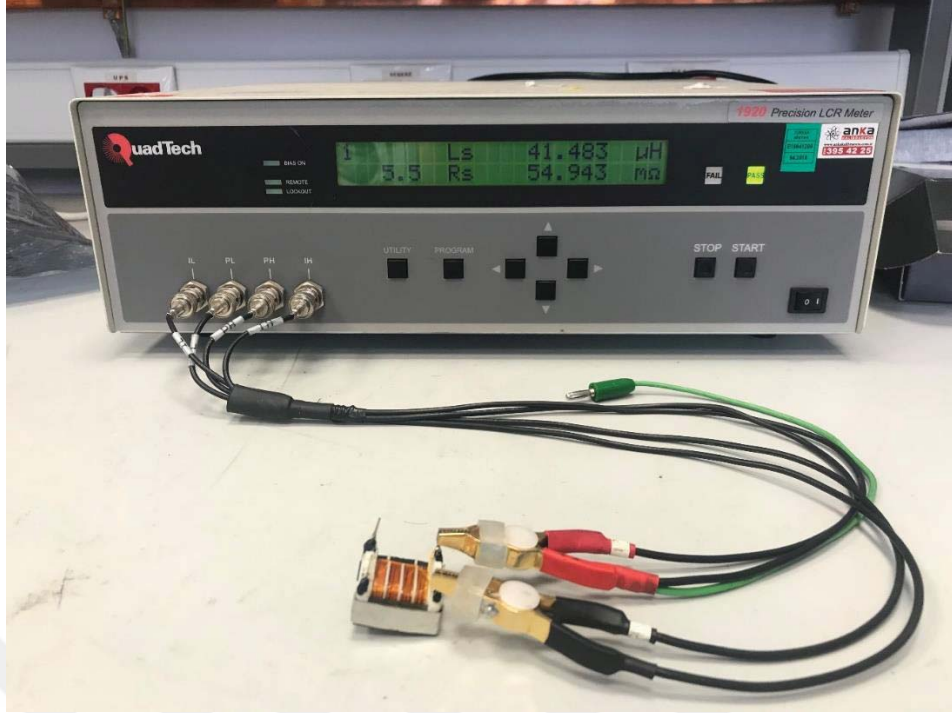
Şekil 5.2. Tasarlanan transformatörü parametrelerinin ölçüm düzeneği.
