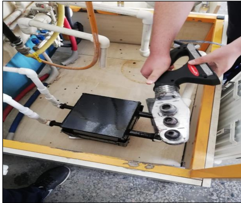
Şekil 4.5. Deney setinin sacdan yapılan kutuların bağlanması
