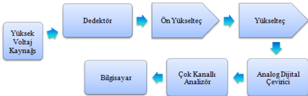
Şekil 2.7. Gama sayımı şematik elektronik sistemi
