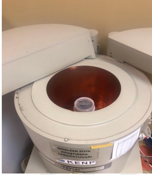
Şekil 2.4. ORTEC GEM25P4-70 model HpGe dedektörünün içi
