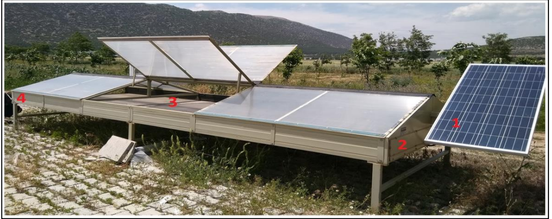
Şekil 3.1. Tünel tipi güneş enerjili kurutucu: (1) güneş pili, (2) havalandırma fanı, (3) güneş kollektörü ve (4) kurutma tüneli
