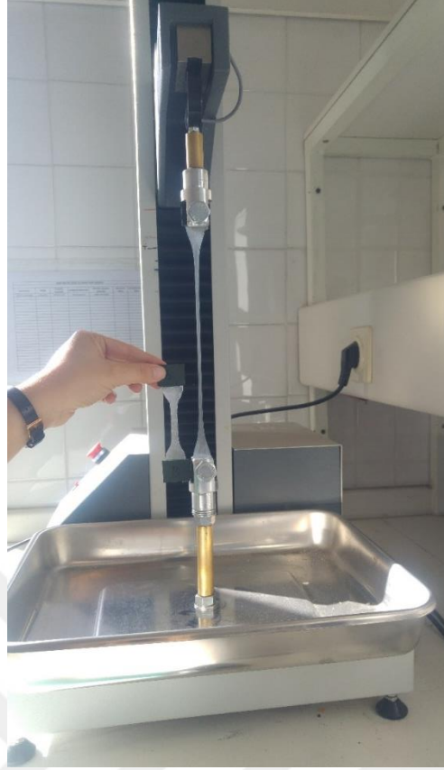
Şekil 3.6 : PU filme çekme testinin uygulanması.
