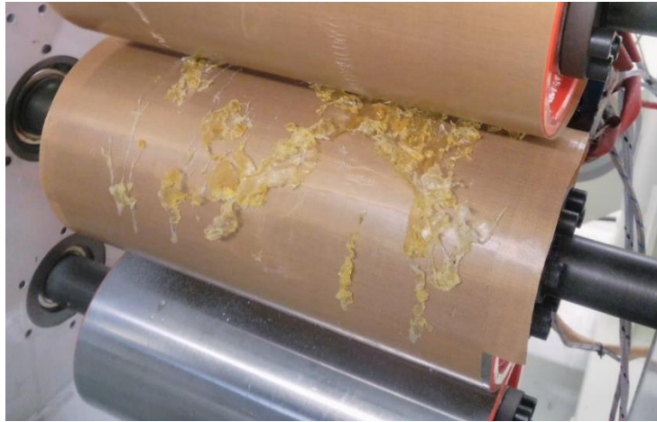
Şekil 4.39 : PU 1500-50-40 6 RPM vida hızı ve 185-193-195-200-200°C sıcaklık.
