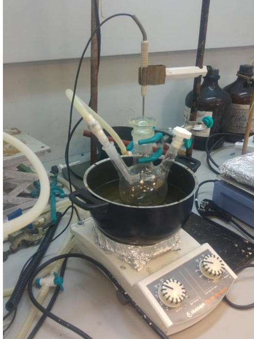
Şekil 3.2 : PU sentezi için oluşturulan reaksiyon düzeneği.
