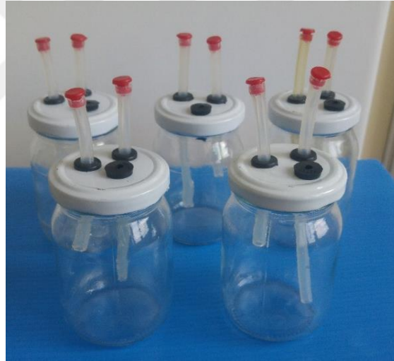
řekil 3.10 : Solunum hızı lm iin kullanılan kapalı sistem kavanozlar.
