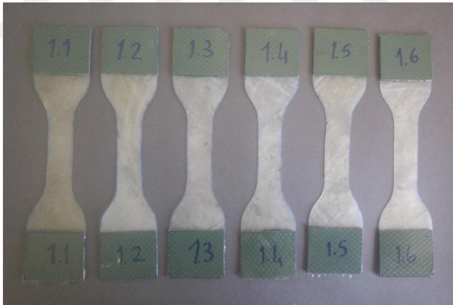
Şekil 3.5 : Çekme testi için hazırlanan film örnekleri.
