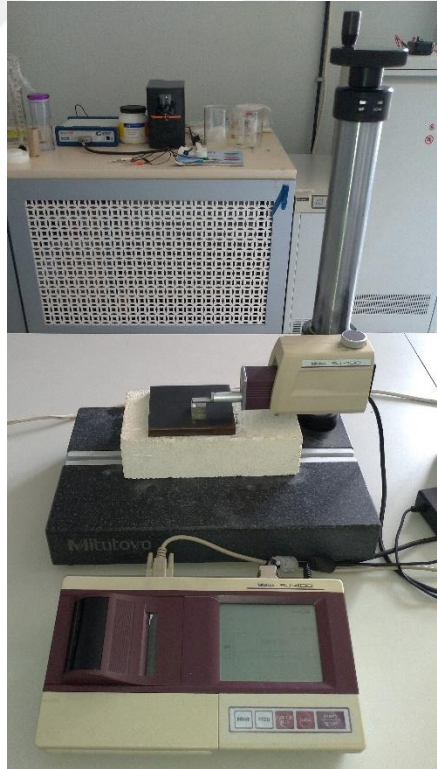
Şekil 3.15. Mitutoyo SJ-401 yüzey profilometresi
