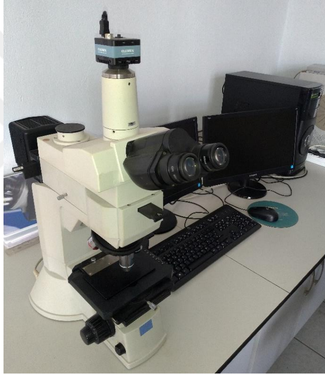
Şekil 3.11. Nikon Eclipse L150 optik mikroskop
