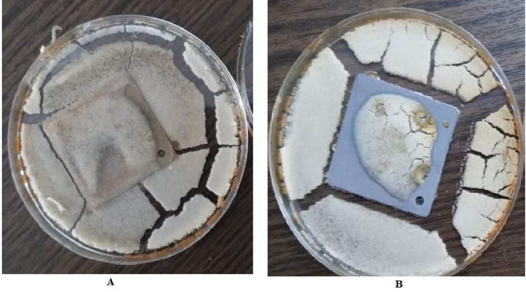
Şekil 4.42. Mikroorganizma gelişimi sonunda; a) aşındırılmamış yüzeye sahip grafen katı ortam görüntüsü, b) sülfürik asit ile aşındırılarak üretilen grafen katı ortam görüntüsü
