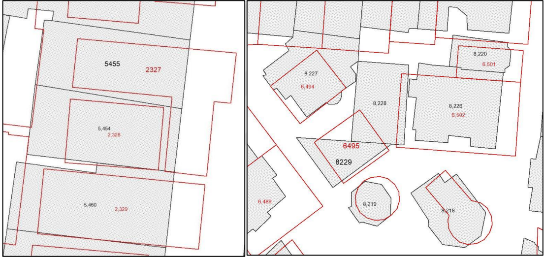
Şekil 5.10 Yüksek dikdörtgensellik farkı üreten bina detay örnekleri (soldaki TOPO bina detayı (5455) OSM bina detayından (2327) daha dikdörtgensel yani daha basit bir şekle sahip iken sağdaki bina detayları (TOPO: 8229 ↔ OSM: 6495) için tam tersi bir durum söz konusudur.)
