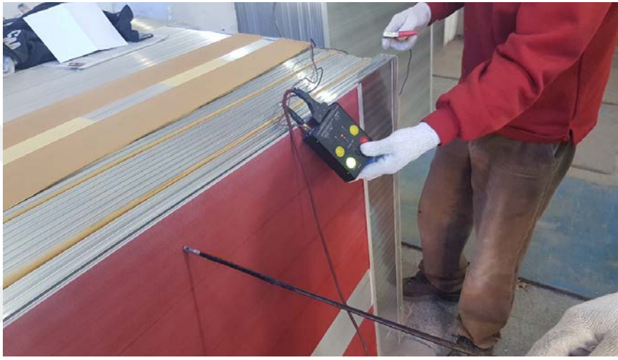
Resim 39: Pistin İletkenliğinin Denetlenmesi
