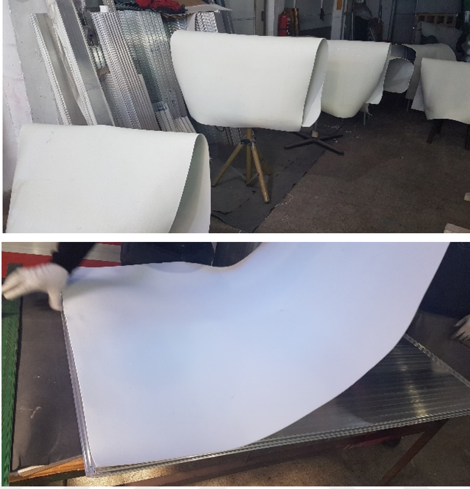
Resim 36: PVC lerin pistin altına yapıştırılma aşamalarından görüntüler
