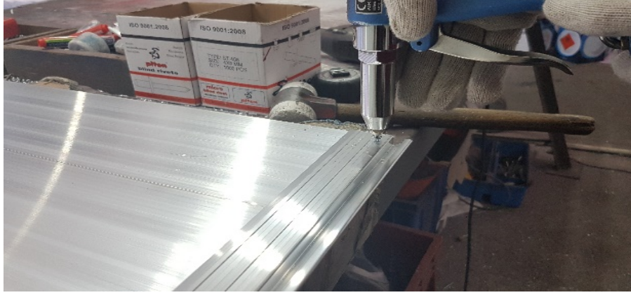
Resim 32: U Profillerin Plakalara Geçirilme Sonrası Perçinleme Aşamaları
