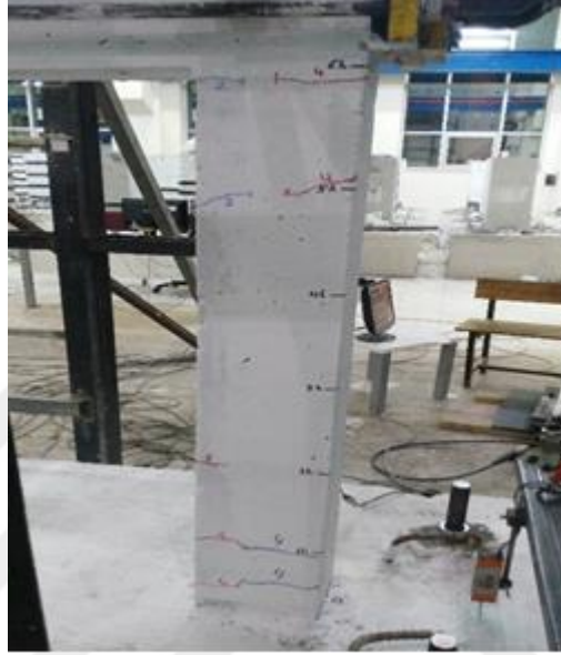
Şekil 3.24. ilk dört döngü sonunda oluşan çatlaklar.
