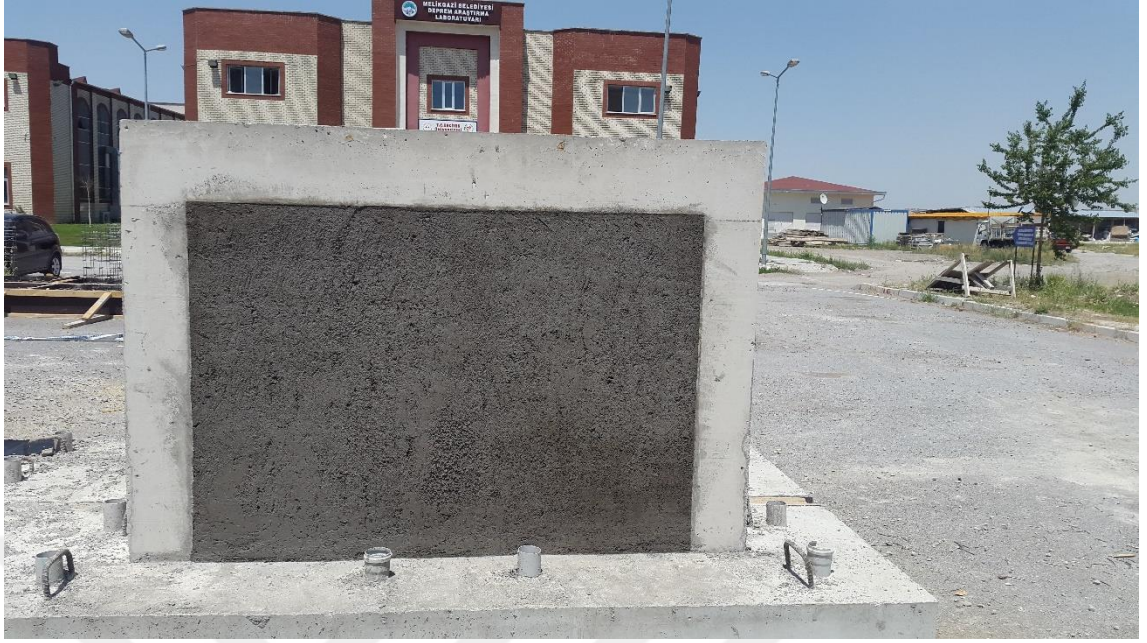
Şekil 3.11. Sıva uygulanmış dış yüzey
