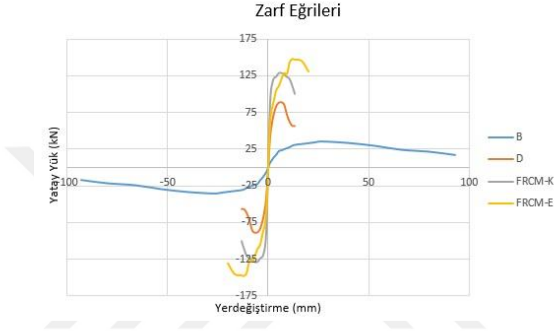
Şekil 4.5. B, D, FRCM-K, FRCM-E numunelerinin kıyaslamalı zarf eğrileri
