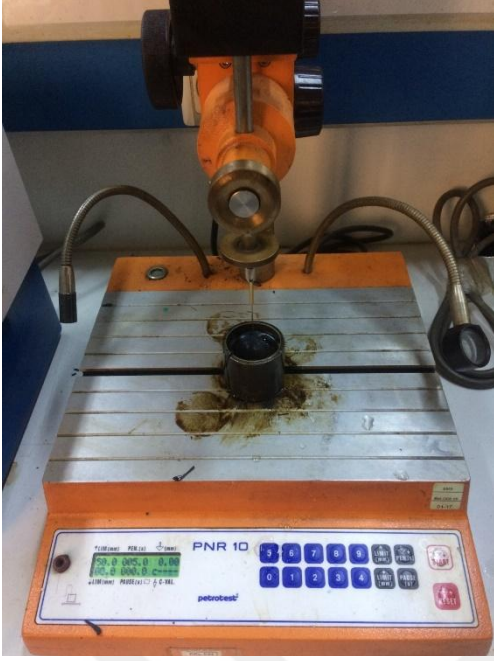
Şekil 3.15 Penetrasyon cihazında yapılan testte iğnenin batma ölçümü
