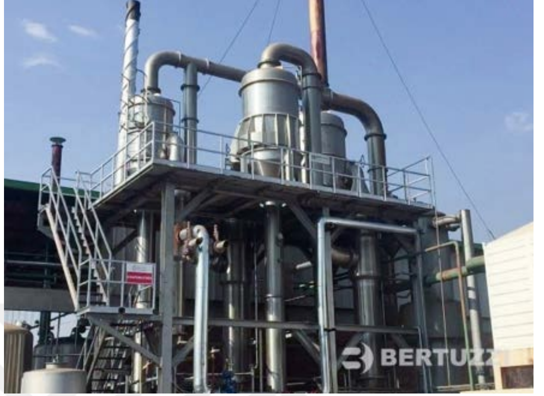
Şekil 3.10. Kayısı püre konsantresi üretiminde kullanılan 2 etkili bir evaporatör sistemi (Bertuzzi, 2019)
