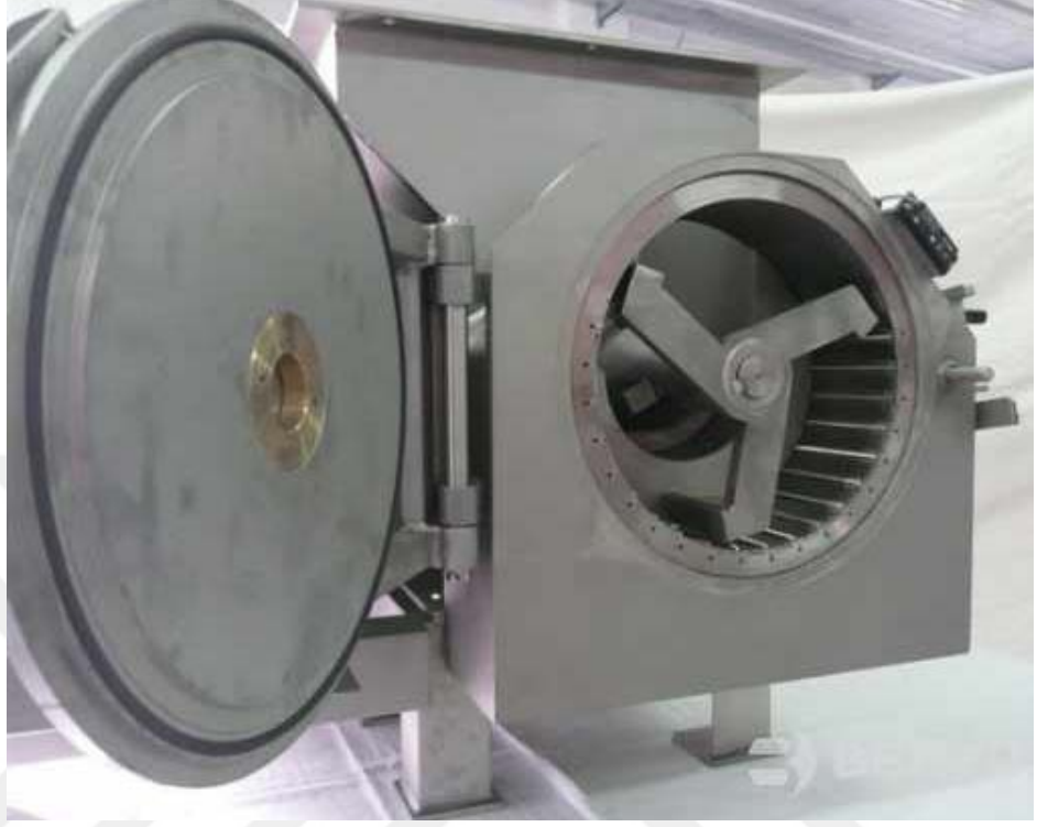
Şekil 3.6 Meyve parçalama için kullanılan bir parçalayıcı (Bertuzzi, 2019)
