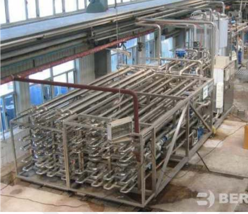
Şekil 3.12 Aseptik dolum öncesi sterilizasyon için kullanılan borulu bir ısı deęiřtirici (Bertuzzi,2019)
