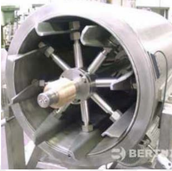
Şekil 3.9. Kayısı püresi elde etmek için kullanılan bir palper (Bertuzzi, 2019)
