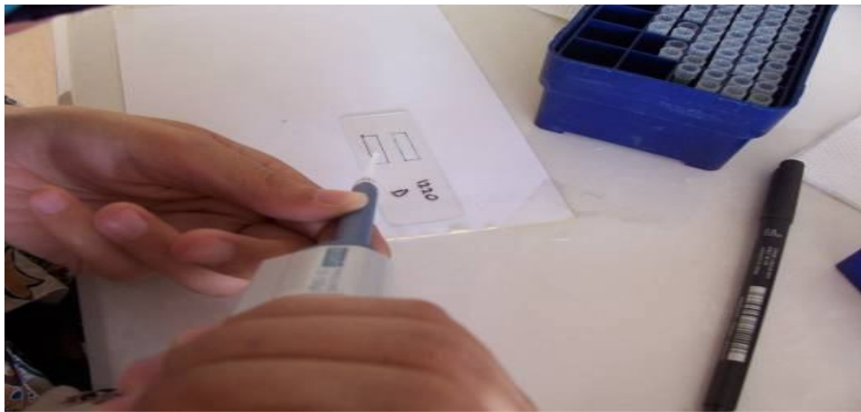
Şekil 2. Lam üzerine mikropipet ile sütün yayılımı
