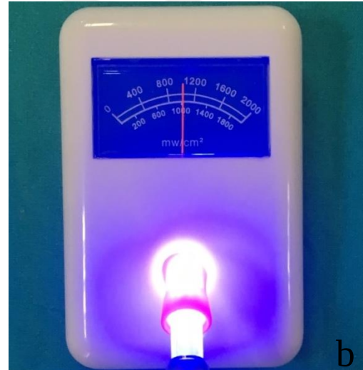
Resim 4. Çalışmada kullanılan (a) radyometre cihazı ve (b) ışık şiddetinin ölçülmesi
