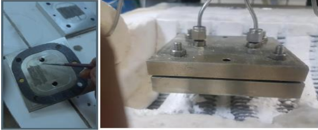
Resim 4.2. Mikro kanallı reaktörün katalizör ile kaplanma süreci ve fırına yerleştirilmesi
