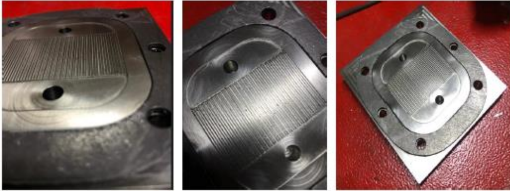
Resim 4.1. Üretilen mikro kanallı reaktördeki kanalların görüntüsü
