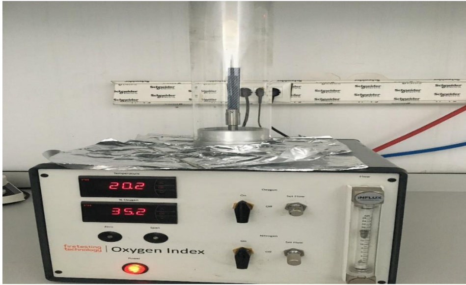
Resim 3.15. LOI test cihazı
