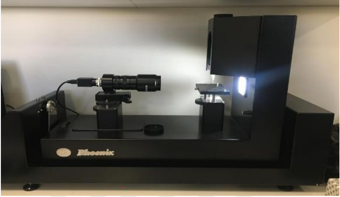
Resim 3.11 Temas açısı ölçüm cihazı
