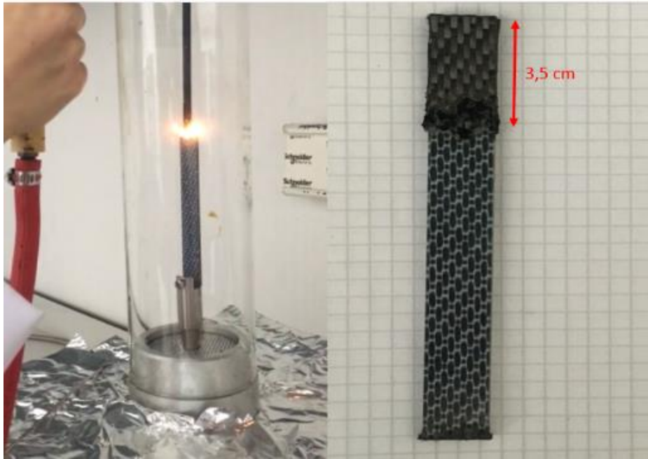
Resim 4.1. 50KE/PPS numunesinin LOI test görüntüleri
