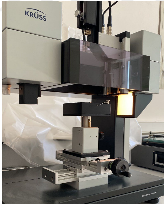
Şekil 3.3. Temas açısı ölçüm cihazı (Krüss)
