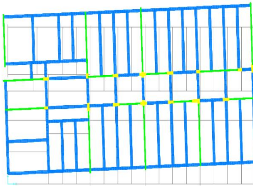
Şekil 9.18. Güçlendirilmiş yapı y periyodunda mod şekli
