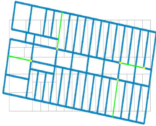
Şekil 7.72. Mevcut yapı burulma mod şekli
