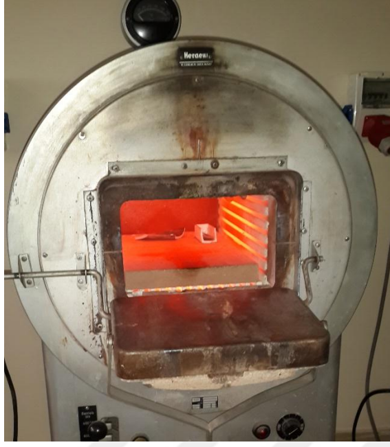
Şekil 4.5. Kutu tipi Heraeus KR250 marka tav fırınında ısıl işlem uygulaması
