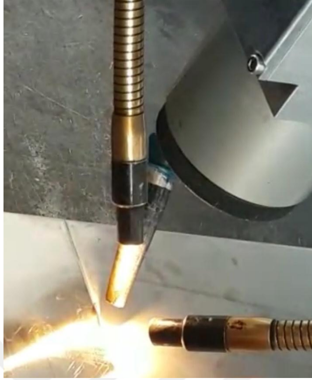
Şekil 4.2. Deneylerde kullanılan lazer kaynaklı malzemelerin kaynak işlemi
