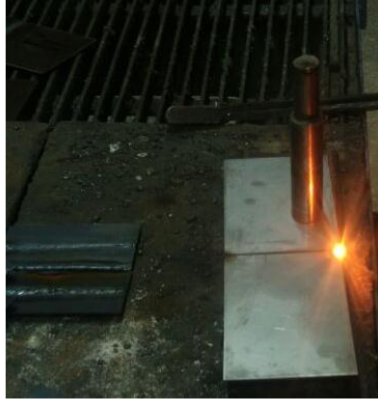
Şekil 4.3. Deneylerde kullanılan TIG kaynaklı malzemelerin kaynak işlemi
